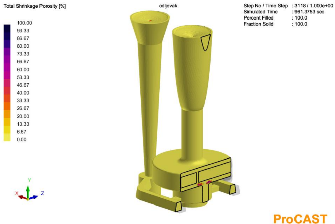
Slika 47. Vjerojatnost nastanka poroznosti u poprečnom presjeku 1
