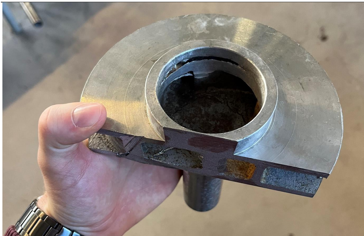
Slika 26. Greške na odljevku
