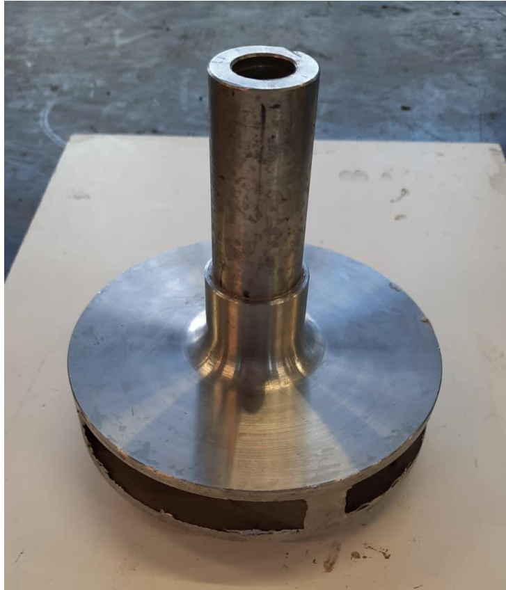
Slika 25. Impeler od nehrđajućeg čelika
