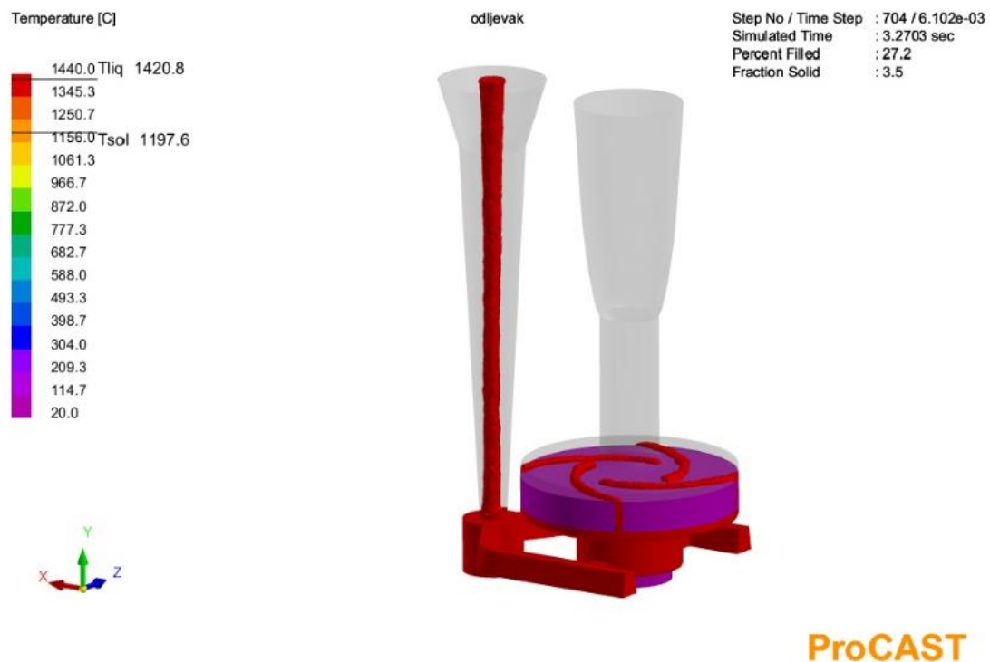
Slika 37. Punjenje kalupa nakon 1,5 sekunde
