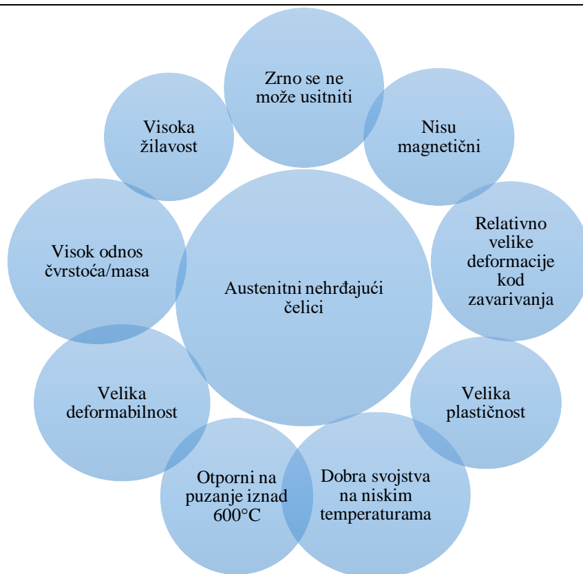
Slika 5. Svojstva austenitnih nehrđajućih čelika [4]
