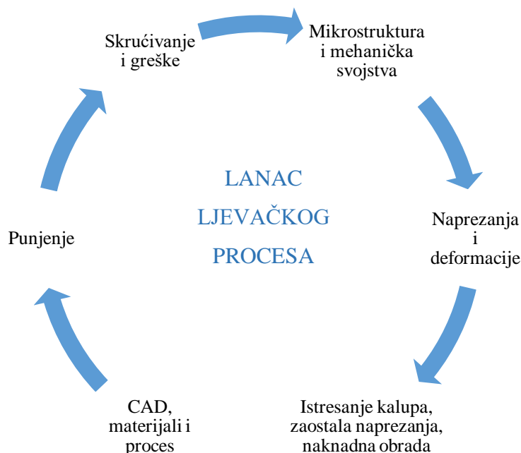
Slika 23. Lanac ljevačkog procesa [13]
