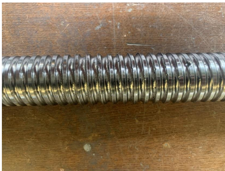
Slika 42. Prikaz oštećenja kugličnog navojnog vretena Z osi
