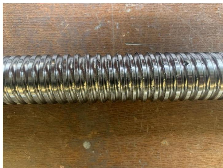
Slika 42. Prikaz oštećenja kugličnog navojnog vretena Z osi
