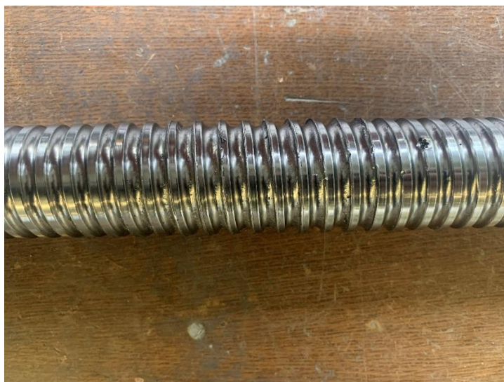
Slika 42. Prikaz oštećenja kugličnog navojnog vretena Z osi
