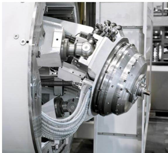
Slika 10. Primjer stroja s paralelnom kinematikom [8]
