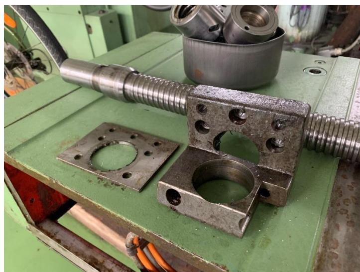
Slika 39. Nosač gornjeg radijalnog ležaja Z osi
