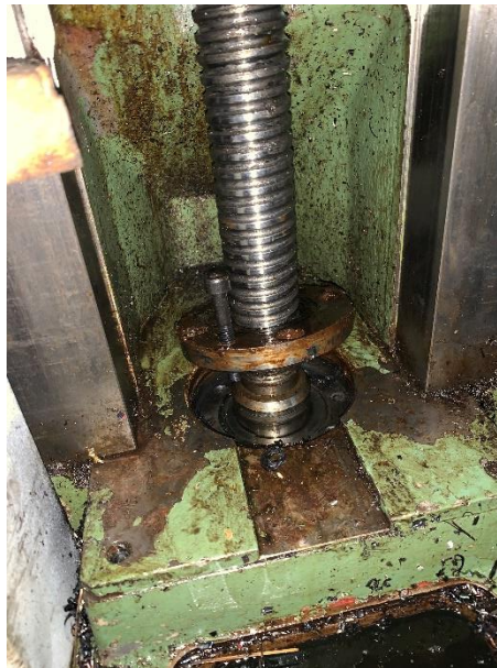
Slika 38. Prsten za prednapreznje ležajeva u reduktoru
