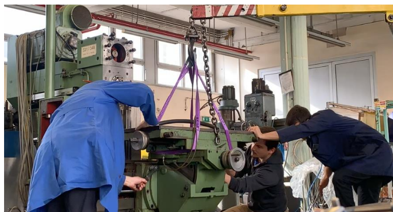
Slika 37. Demontaža stola glodalice
