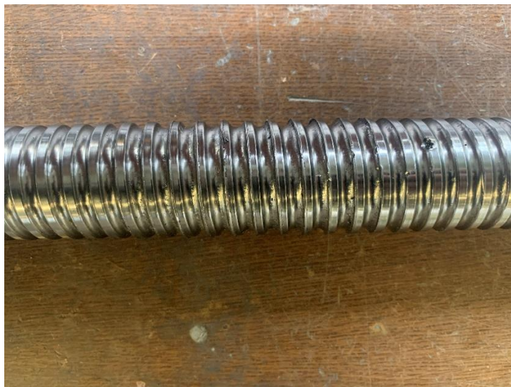
Slika 42. Prikaz oštećenja kugličnog navojnog vretena Z osi
