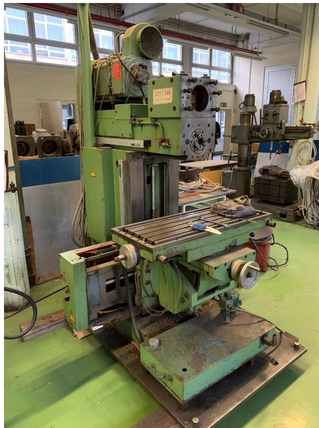
Slika 24. 9-osna glodalica SHW-UF11
