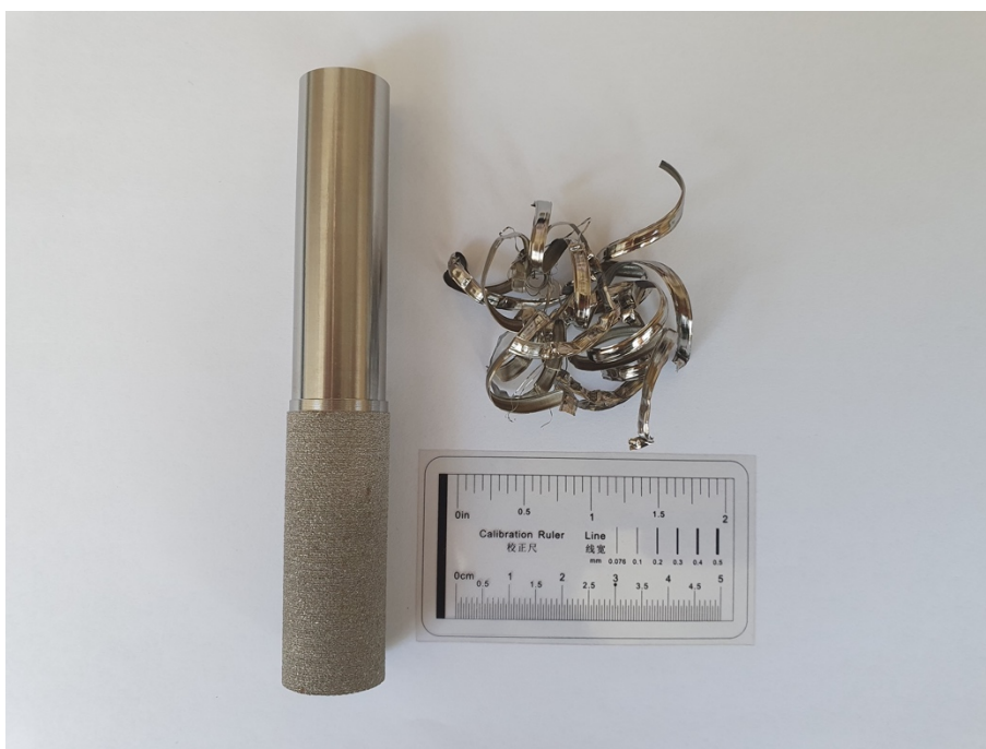
Slika 8.3. Fino tokaren uzorak S3
