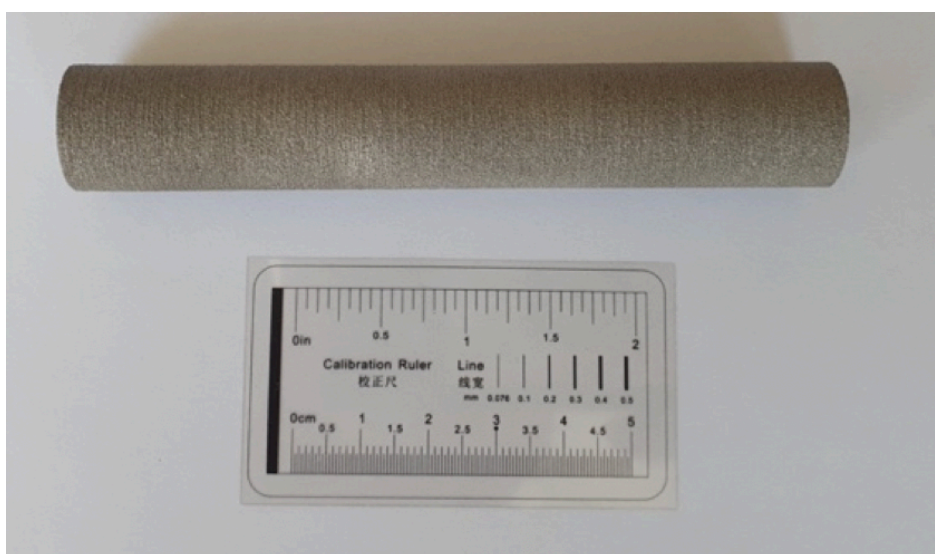
Slika 7.1. Uzorak proizveden aditivnom proizvodnjom u polaznom stanju
