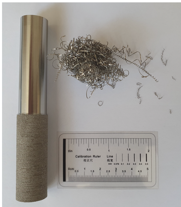
Slika 8.2. Fino tokaren uzorak S2
