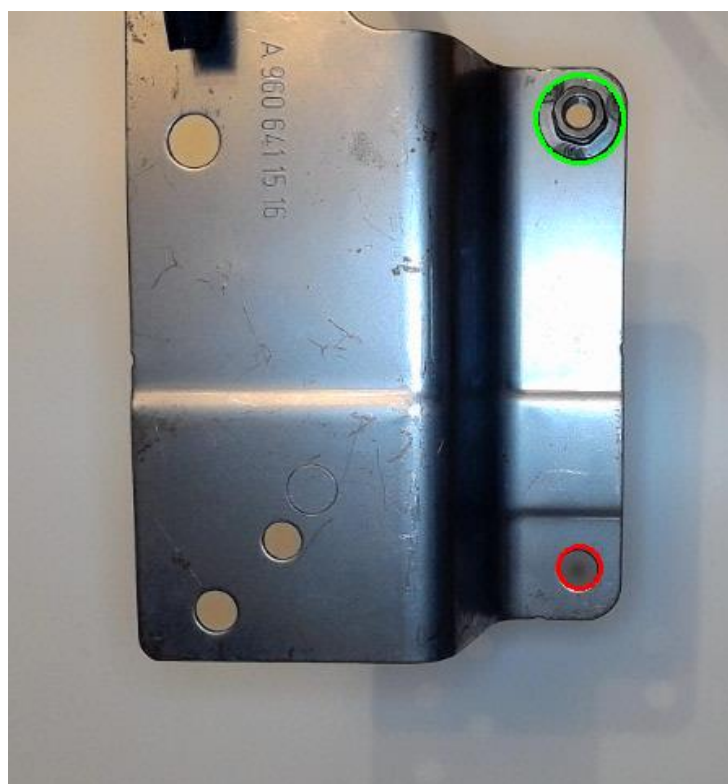
Slika 100. Vizijska kontrola dijela - zavarena samo prva matica
