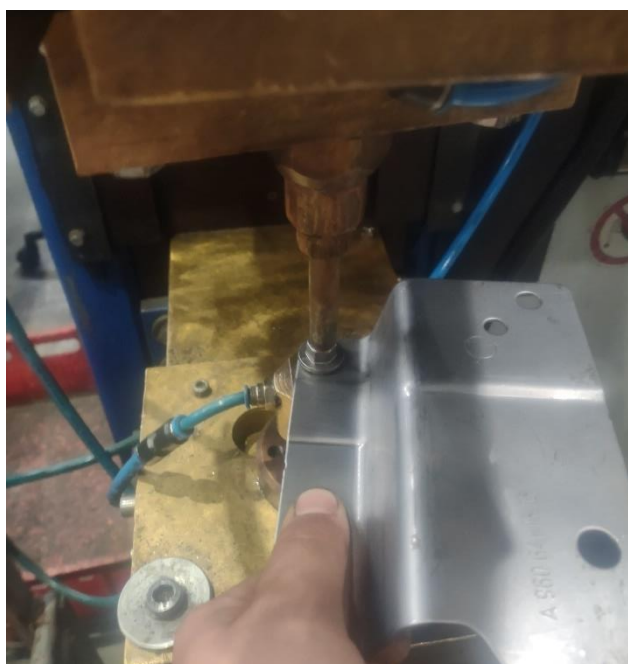
Slika 10. Aktivacija radnog ciklusa stroja za varenje
