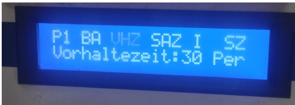
Slika 23. Podešavanje VHZ parametra
