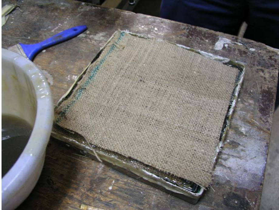
Slika 4.6. Stavljanje sloja jute
