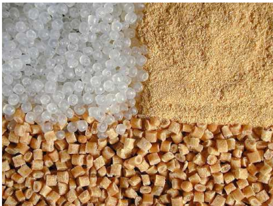
Slika 2.11. Granule polietilena, drveno brašno i granula DPK-a [6]
