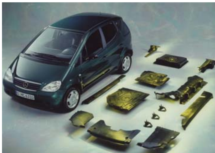
Slika 2.9. Dijelovi automobila izrađeni od kompozita ojačanog prirodnim vlaknima [5]
