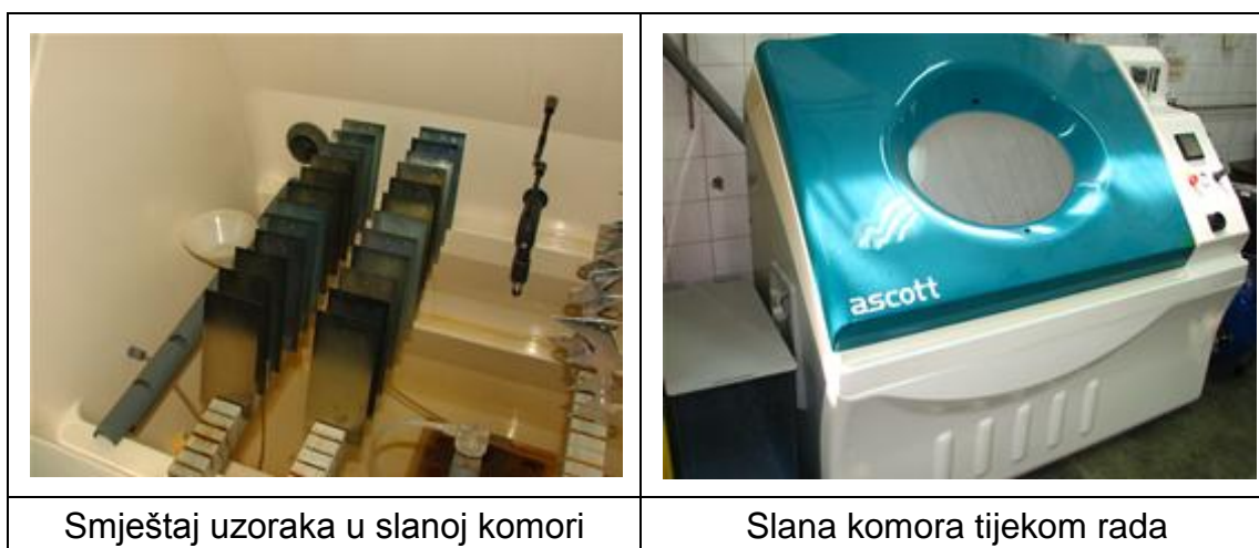
Slika 15. Slana komora u Laboratoriju za zaštitu materijala Fakulteta strojarstva i brodogradnje u Zagrebu
