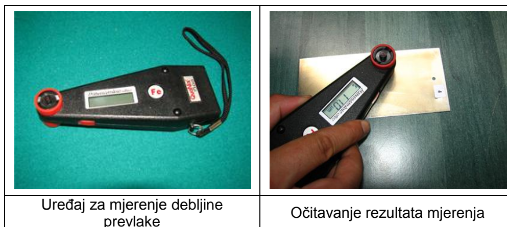
Slika 14. Mjerenje uređajem za mjerenje debljine prevlake
