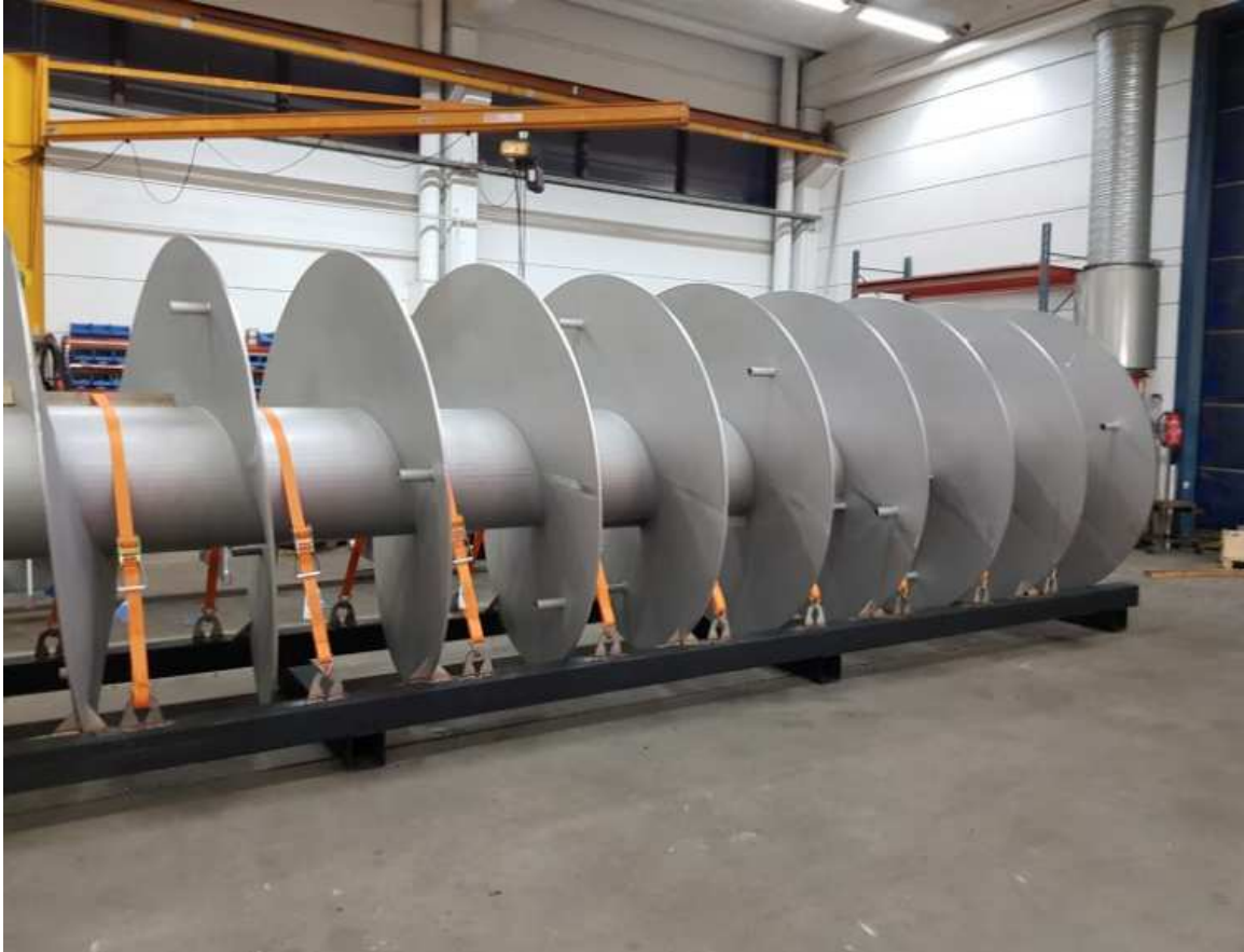
Slika 11. Siirtruuvi velika pužnica dimenzija \text{Ø}2075 \times 12125 [5]
