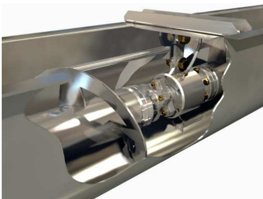
Slika 8. Meduležaj na vratilu pužnice [4]
