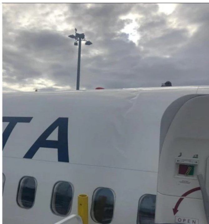
Slika 5. Nabor oplata trupa zrakoplova uslijed tvrdog slijetanja [7]
