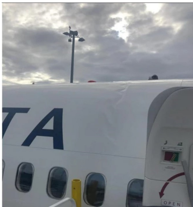
Slika 5. Nabor oplata trupa zrakoplova uslijed tvrdog slijetanja [7]
