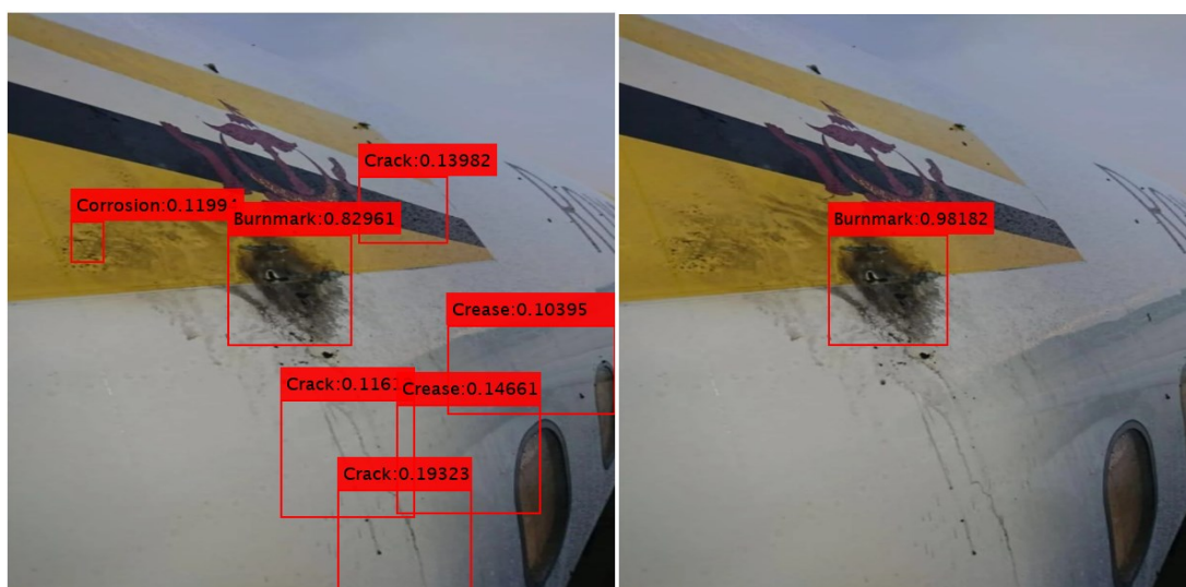
Slika 53. Detekcija udara groma ( burnmark ) pomoću YOLO v2 algoritma (lijevo) i YOLO v4 algoritma (desno)
