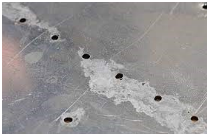
Slika 1. Površinska korozija zrakoplova [2]
