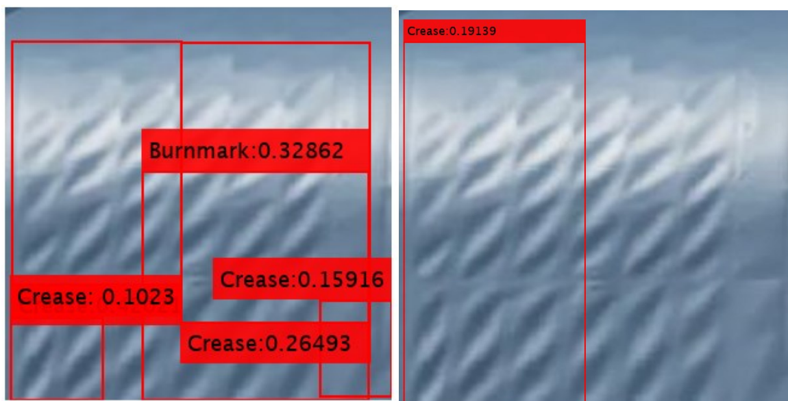
Slika 55. Detekcija nabora ( crease ) pomoću YOLO v2 algoritma (lijevo) i YOLO v4 algoritma (desno)
