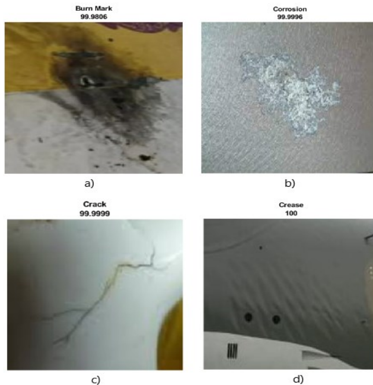
Slika 44. Rezultati klasifikacije anomalija trupa zrakoplova a) Klasifikacija udara groma b) Klasifikacija korozije c) Klasifikacija pukotine d) Klasifikacija nabora
