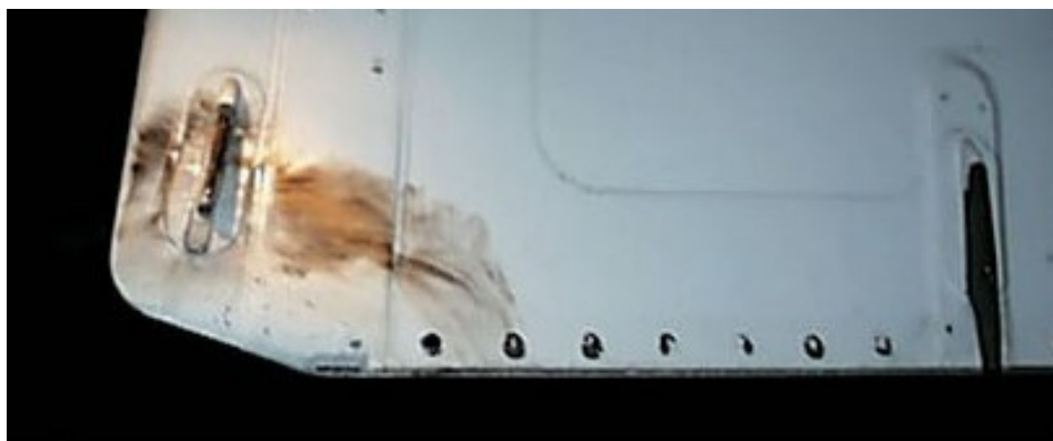
Slika 4. Oštećenje horizontalnog stabilizatora zbog udara groma [6]
