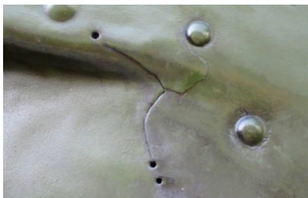
Slika 2. Pukotina nastala zbog velikih vibracija [3]
