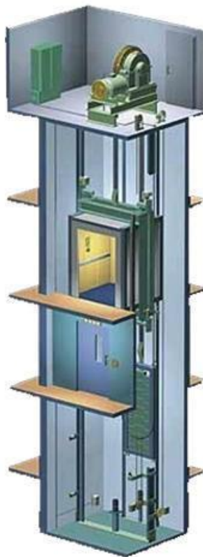
Slika 11. Užetni lift na električni pogon
