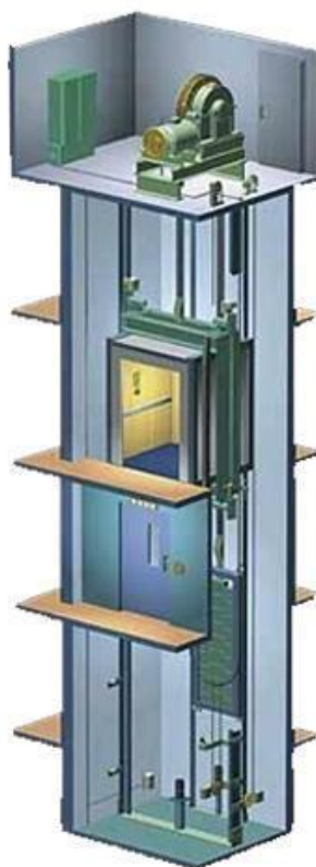
Slika 11. Užetni lift na električni pogon
