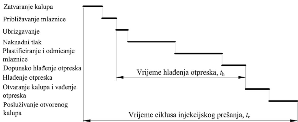
Slika 2.2. Vremenski tijek injekcijskog prešanja [1]
