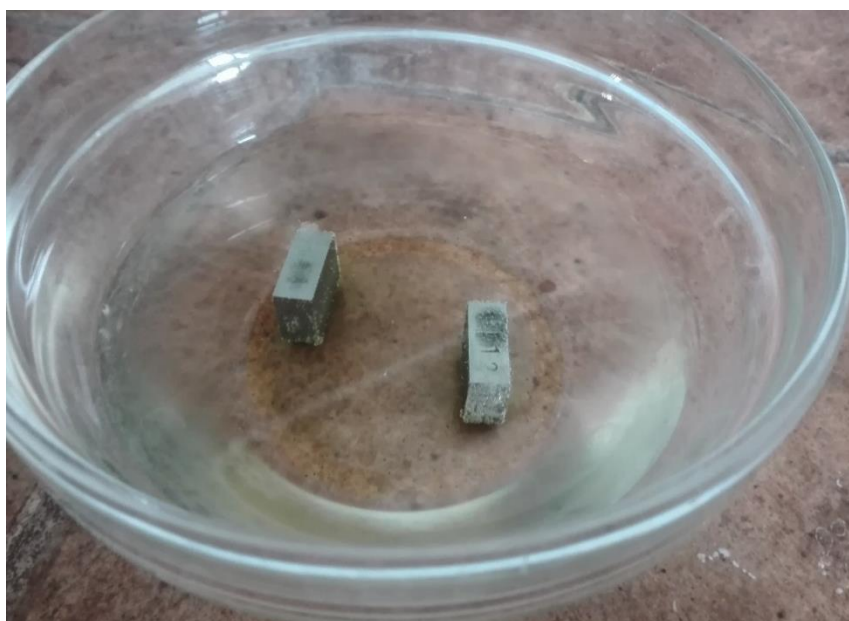
Slika 18. Kemijsko nagrivanje uzoraka u otopini \text{HNO}_3 + \text{HF} + \text{H}_2\text{O}_2
