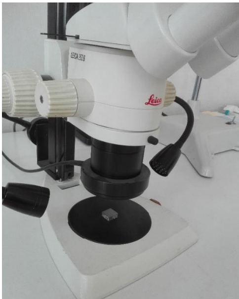
Slika 19. Stereo mikroskop za snimanje mikrostrukture uzoraka
