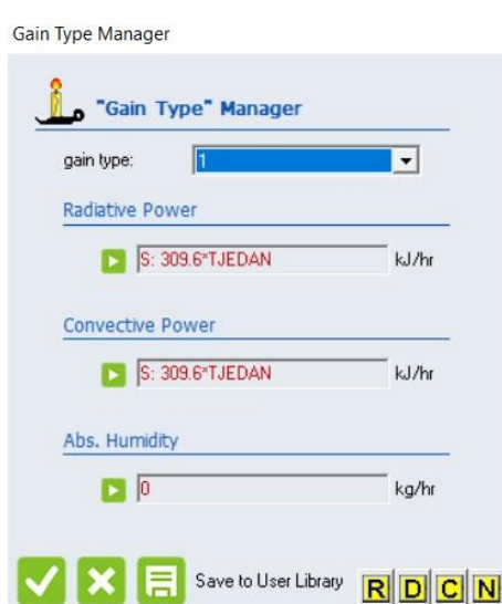
Slika 24 Primjer definiranja unutarnjih dobitaka u sučelju TRNBuild
