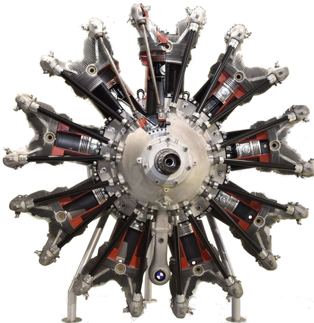
Slika 1. Deveterocilindrični zrakoplovni zvjezdasti motor BMW 132 [2]
