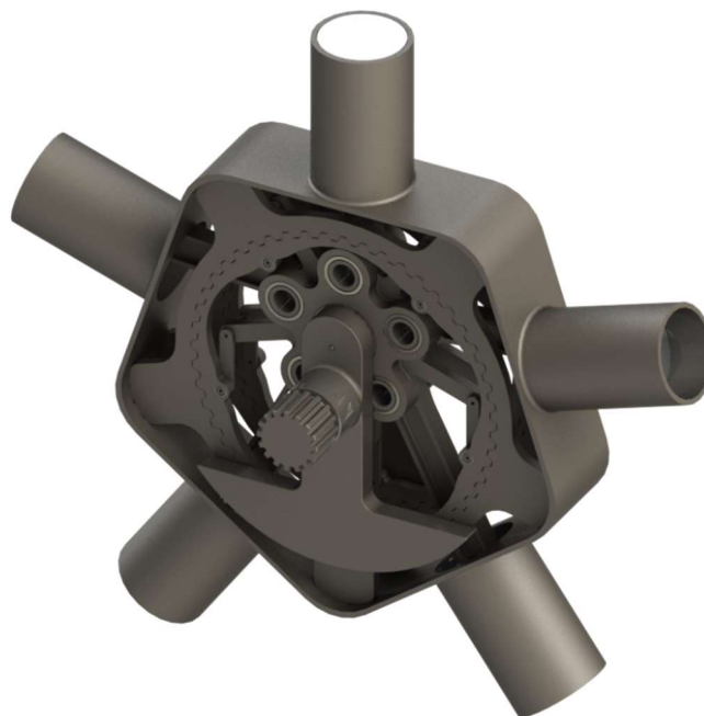
Slika 124. Aksonometrijski prikaz a) sklopa koljenastog vratila i b) punog presjeka koljenastog vratila
