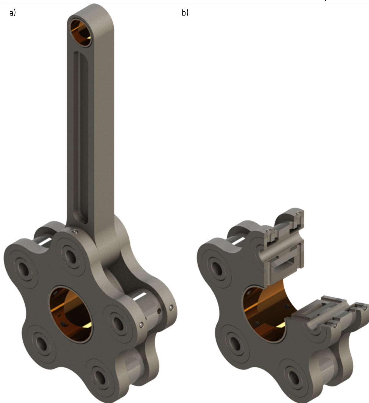
Slika 26. Aksonometrijski prikazi a) glavne klipnjače i b) djelomičnog presjeka prihvatnog dijela glavne klipnjače [16]
