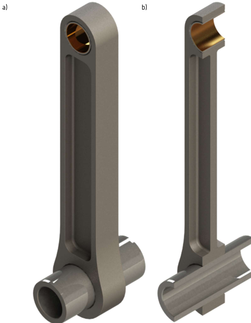
Slika 87. Klipnjača s osovinicom i ležajem male glave u a) aksonometriji i b) aksonometriji punog presjeka
