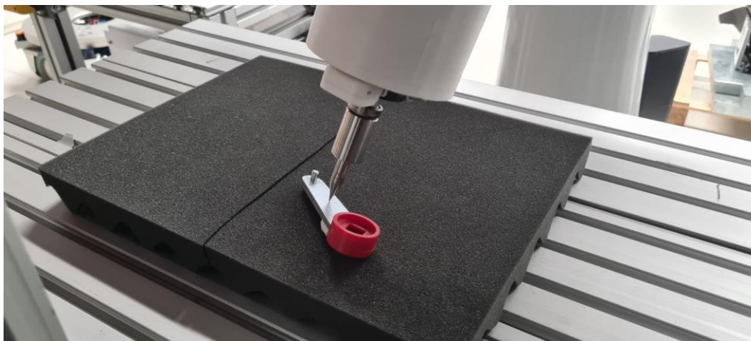
Slika 77. Pozicioniranje robota za slučaj rotiranog komada 2
