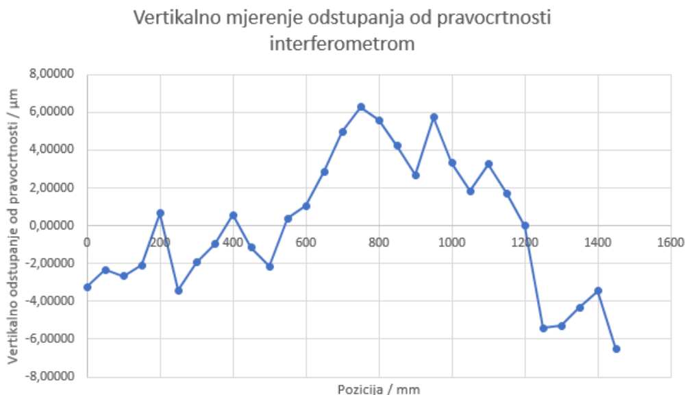
Slika 44. Graf vertikalnih odstupanja od pravocrtnosti mjerenih interferometrom
