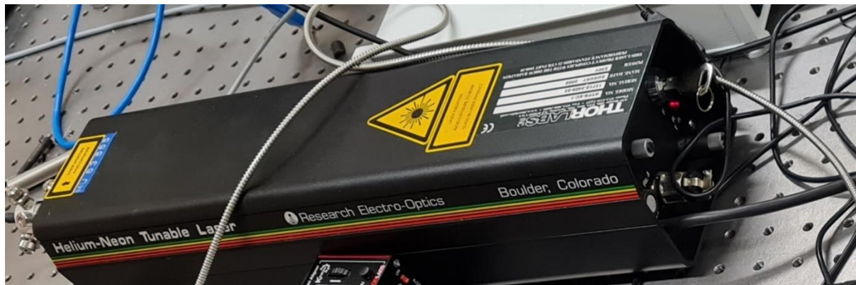
Slika 27. Thorlabs HTPS-EC-1 HeNe laser
