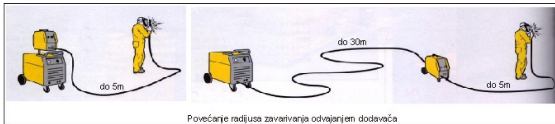
Slika 24. Povećanje udaljenosti zavarivanja odvajanjem dodavača [6]
