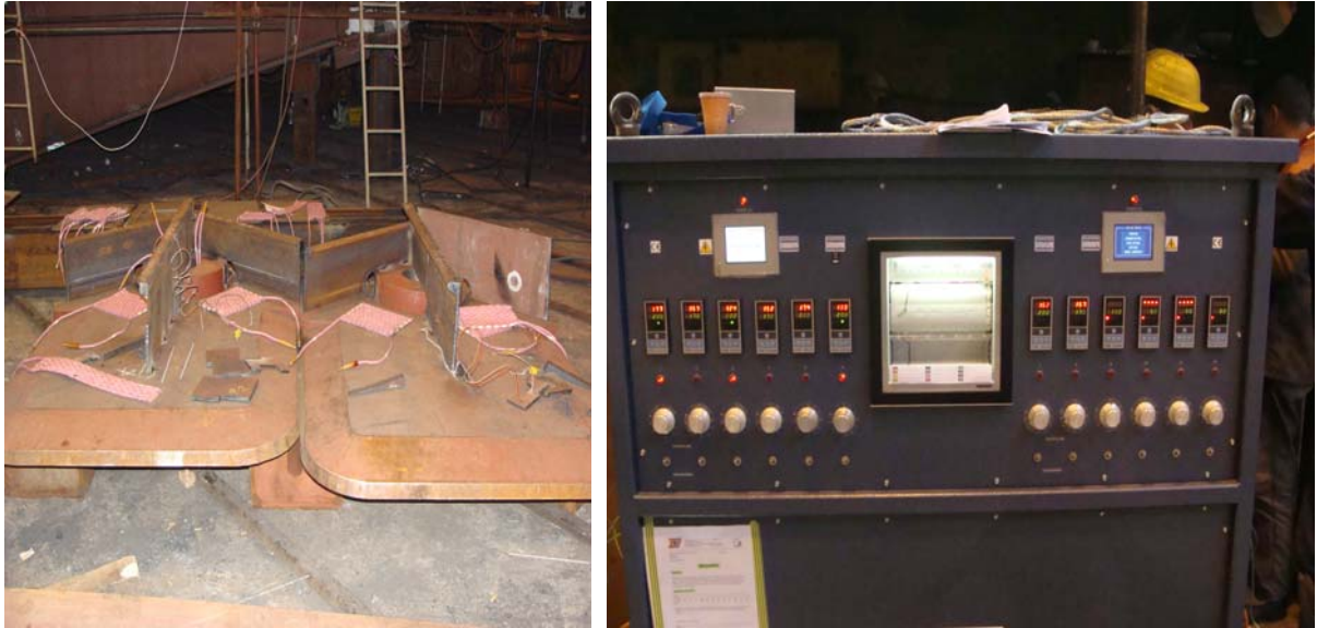
Slika 8 i 9. Grijači za elektro otporno predgrijavanje i elektro otporni uređaj za predgrijavanje, Brodogradilište Uljanik, Pula
