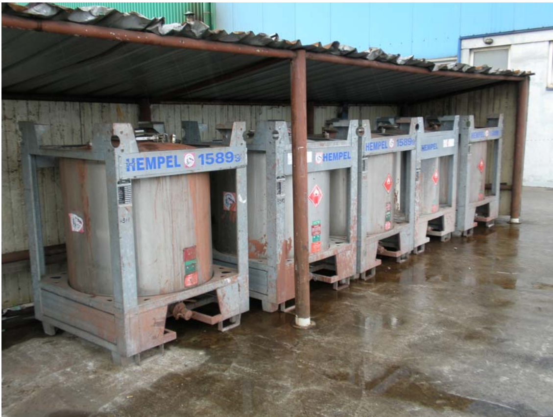
Slika 61. 1000 litreni spremnici "shopprimera", Brodogradilište Uljanik, Pula
