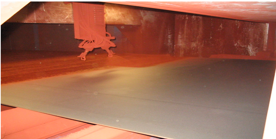
Slika 60. Lim zaštićen "shopprimerom", Brodogradilište Uljanik, Pula
