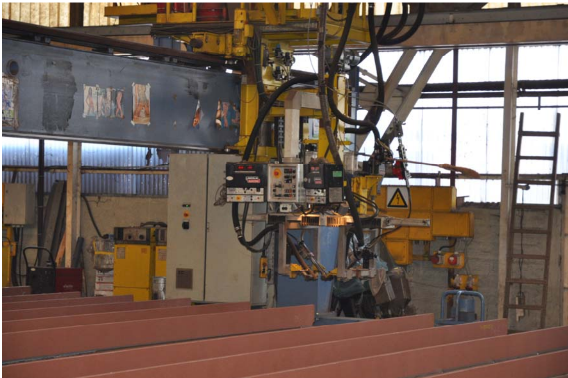
Slika 32. Stroj za kutno EPP zavarivanje, Brodogradilište Uljanik, Pula, svibanj 2010.
