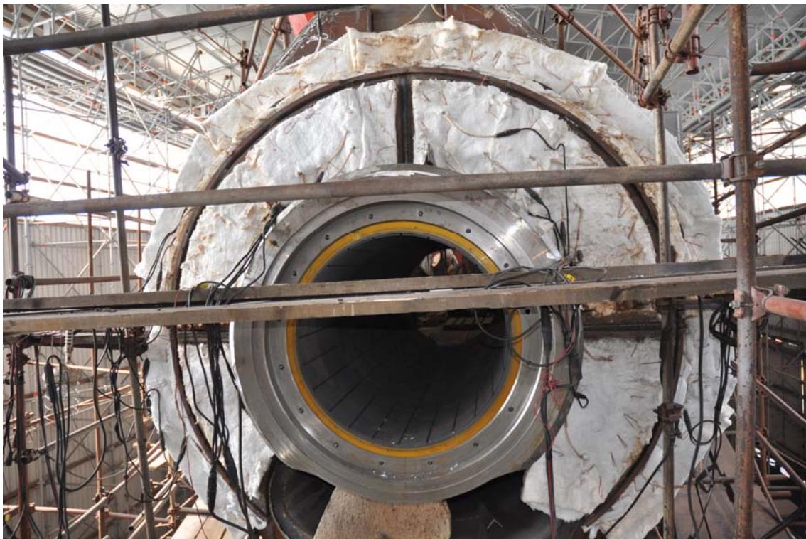
Slika 79. Predgrijavanje prije privarivanja HARDOX ploča, Brodogradilište Uljanik, Pula
