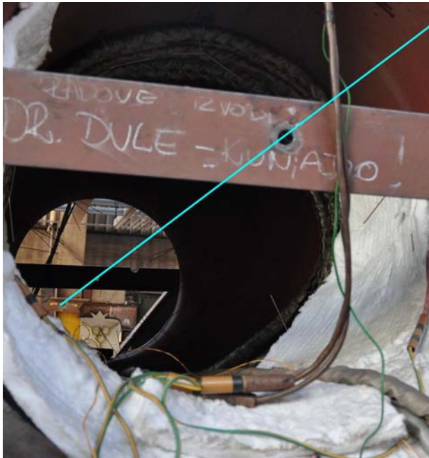
Slika 7. „klavirska žica“ koja se koristi za centriranje odljevaka Brodogradilište Uljanik, Pula
