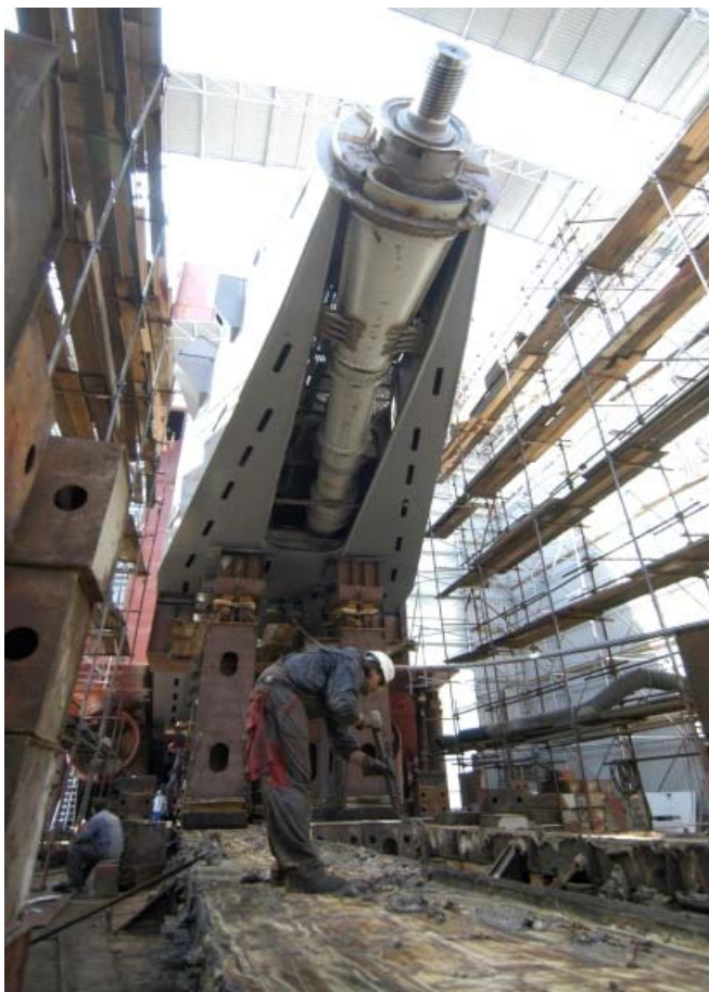
Slika 44. Prikaz kopača broda jaružara prilikom porinuća u krmu broda, Brodogradilište Uljanik, Pula, travanj 2010.
