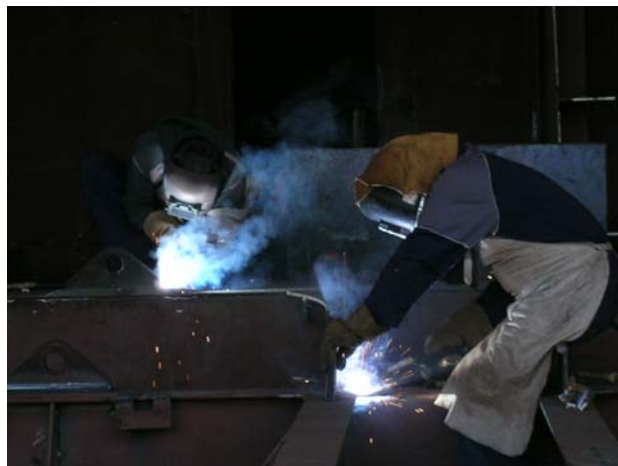
Slika 19 i 20. Princip rada MIG/MAG postupka zavrivanja, zavarivači koji izvode MIG zavarivanje u pogonu predmontaže Brodogradilišta Uljanik, Pula [6]
