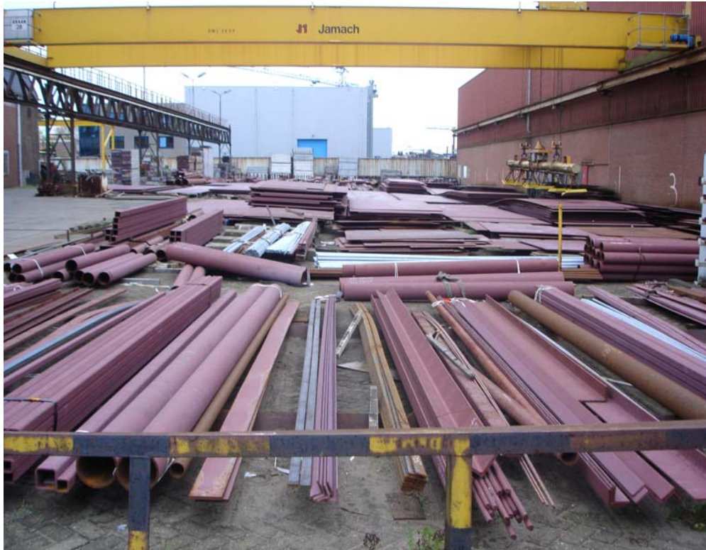
Slika 57. Limovi i profili na skladištu prije same predobrade, Brodogradilište Uljank, Pula
