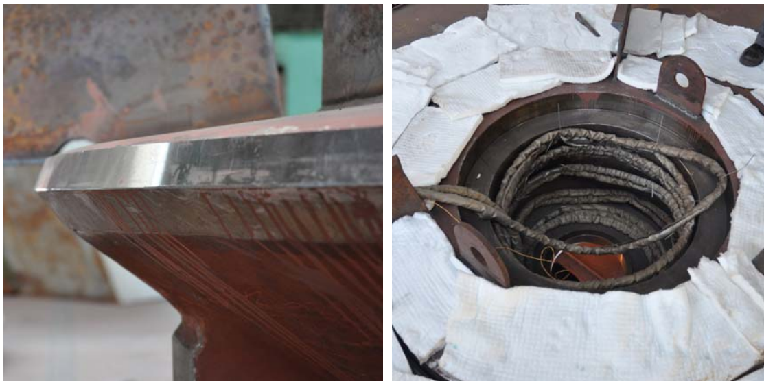
Slika 47 i 48. Skošnje rubova žlijeba, te induktivno predgrijavanje odljevka, Brodogradilište Uljanik, Pula
