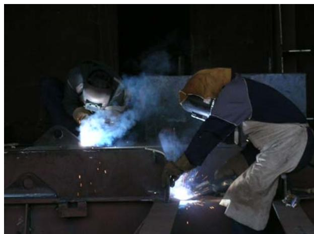
**Slika 19 i 20.** Princip rada MIG/MAG postupka zavrvanja, zavarivači koji izvode MIG zavarivanje u pogonu predmontaže Brodogradilišta Ulijanik, Pula [6]
