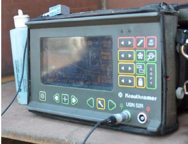
Slika 40. Uređaj za ispitivanje zavara ultrazvukom, Brodogradilište Uljanik, Pula, travanj 2010.
