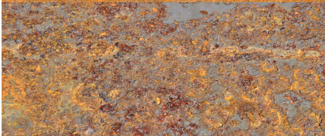
Slika 58. Izgled limova A, B, C i D kategorije prema standardu ISO 8501-1, Brodogradilište Uljanik, Pula
