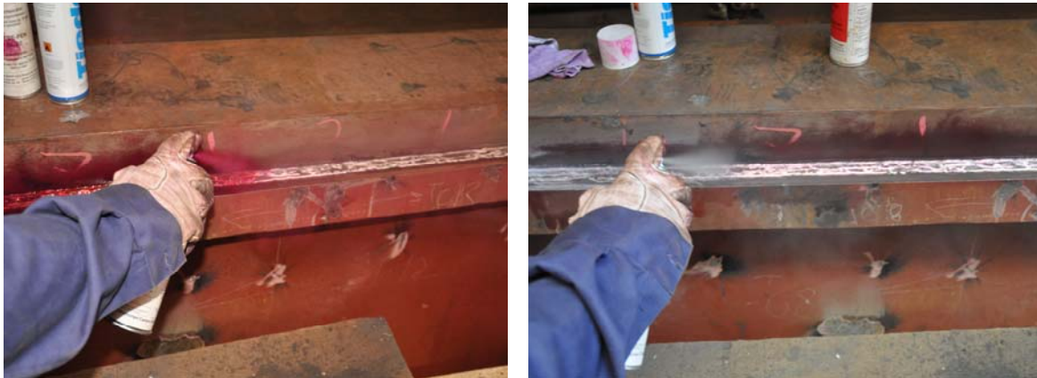
Slika 37 i 38. Nanošenje „crvenog” penetranta, te potom „bijelog” razvijaača, Brodogradilište Uljanik, Pula
