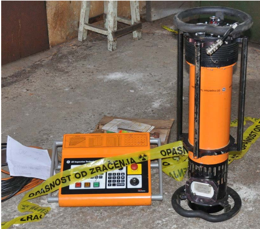
Slika 42. Uređaj za ispitivanje zavara radiografijom, Brodogradilište Uljanik, Pula, travanj 2010.
