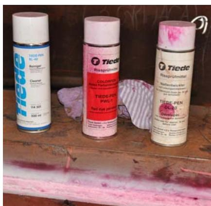
Na prethodno očišćenu i odmašćenu površinu nanosi se penetrant (obično crvene boje). Nakon penetriranja u eventualnu pukotinu, vrijeme penetriranja, tj. prodiranja u pukotine ovisi o vrsti penetranta i o dimenzijama pukotine, ali se približno uzima 10 do 15 minuta, odstranjuje se penetrant na odgovarajući način (vodom, suhom krpom). Kod penetriranih koji se odstranjuju
