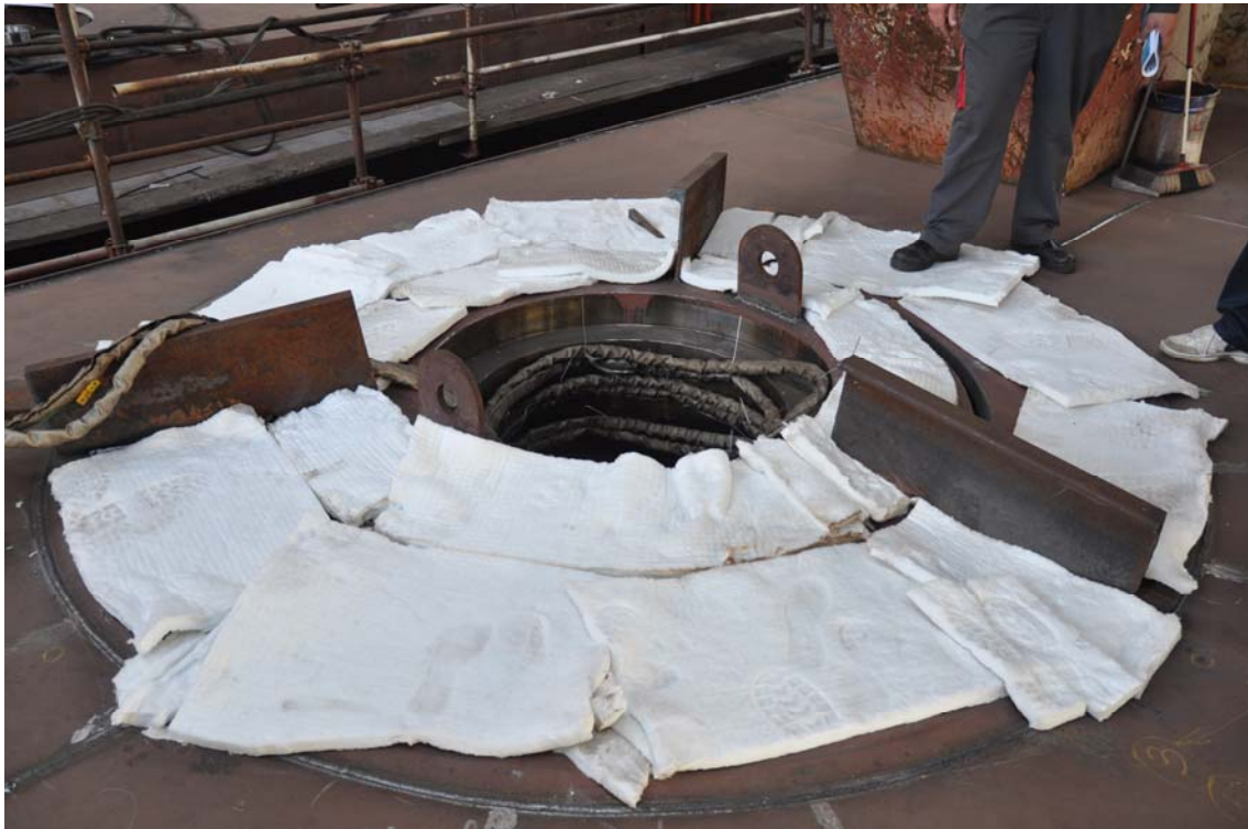
Slika 78. Priprema predgrijavanja na okretnoj točki kopača, Brodogradilište Uljanik, Pula
