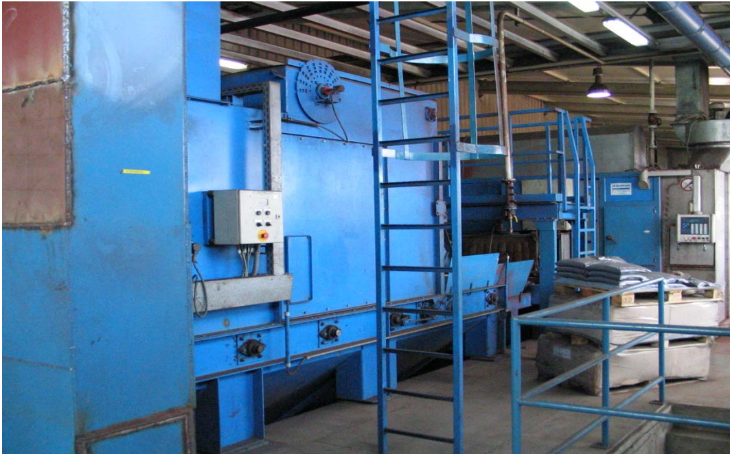
Slika 59. Sačmarilica u eksploataciji, Brodogradilište Uljanik, Pula
