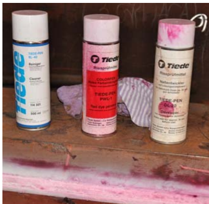
Slika 35. Sprejevi za penetrantsku kontrolu, brodogradilište Uljanik, Pula
