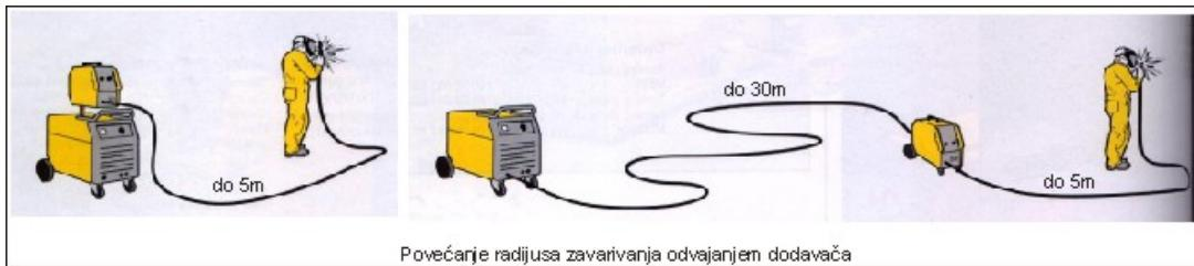
**Slika 24.** Povećanje udaljenosti zavarivanja odvajanjem dodavača [6]
