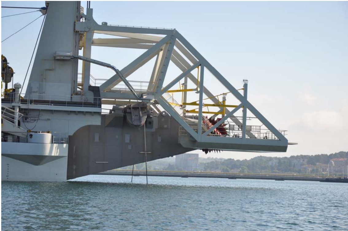
Slika 82. Glava kopača u poziciji u kojoj se nalazi kada nije u funkciji, Brodogradilište Uljanik, Pula
