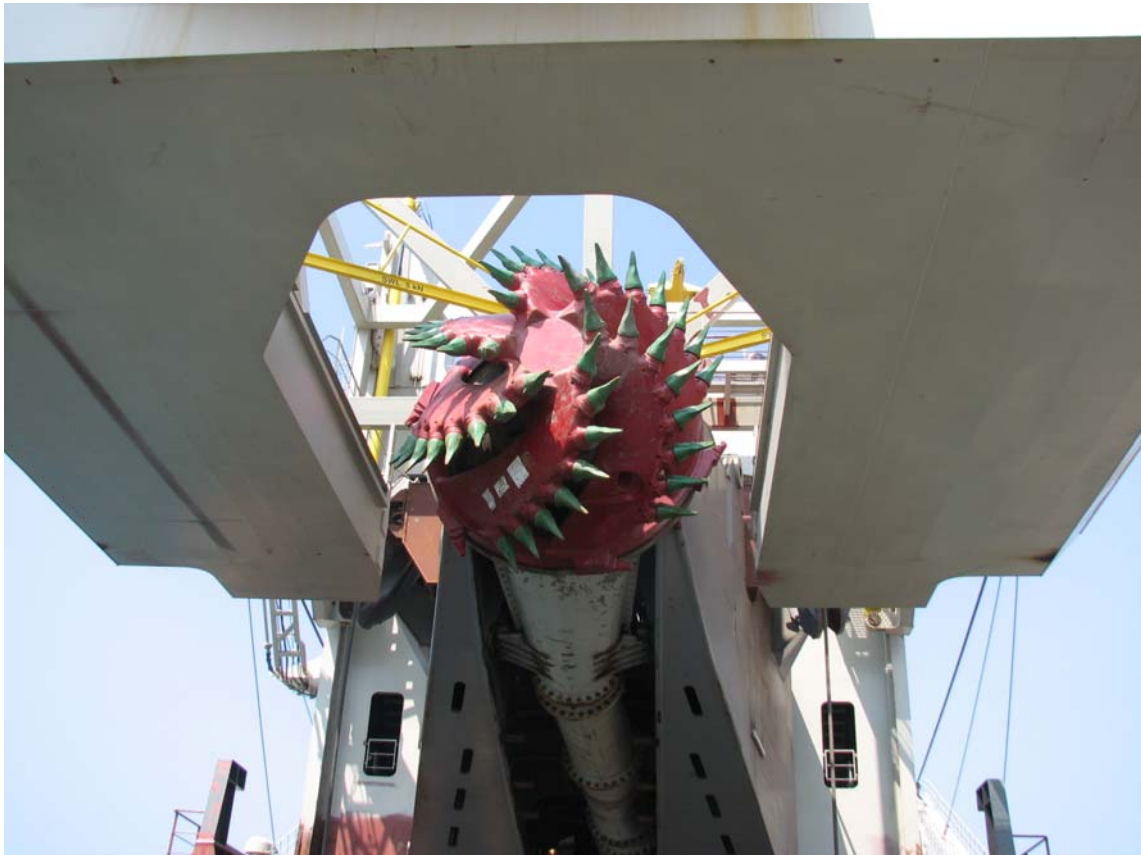
Slika 84. Kopač u poziciji u kojoj se nalazi kada nije u funkciji, Brodogradilište Uljanik, Pula
