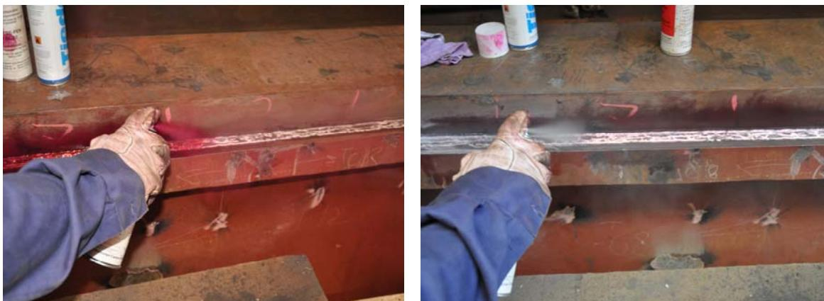
**Slika 37 i 38.** Nanošenje „crvenog” penetranta, te potom „bijelog” razvijača, Brodogradilište Uljanik, Pula
