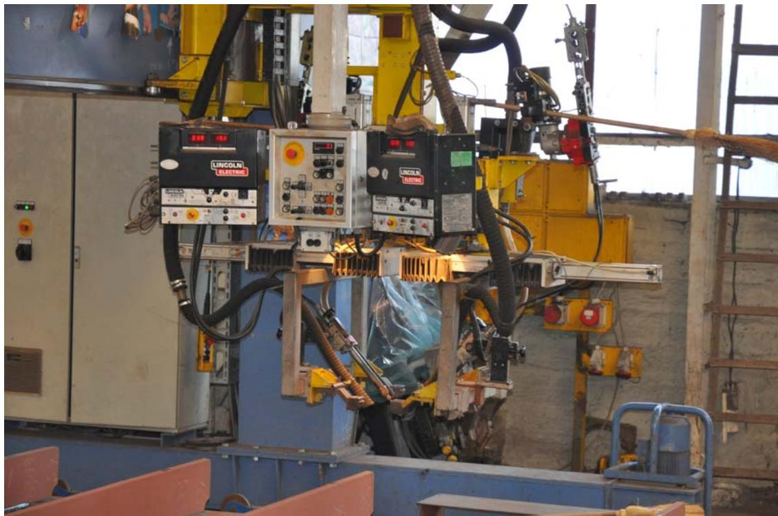
**Slika 33.** Dio opreme za reguliranje parametara i upravljanje strojem za EPP zavarivanje,
