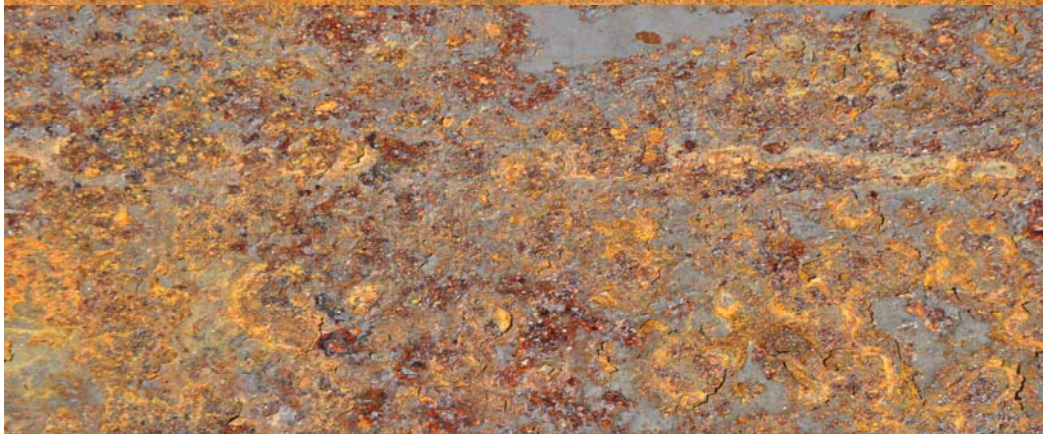
Slika 58. Izgled limova A, B, C i D kategorije prema standardu ISO 8501-1, Brodogradilište Uljanik, Pula
