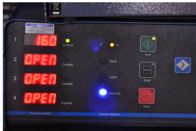
**Slika 12 i 13.** Uređaj za elektro induktivno predgrijavanje, te temperatura predgrijavanja odjlevka [6]
