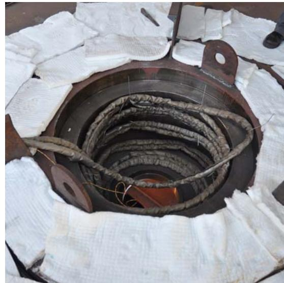
**Slika 47 i 48.** Skošenje rubova žljeba, te induktivno predgrijavanje odljevka, Brodogradilište Ulanik, Pula
