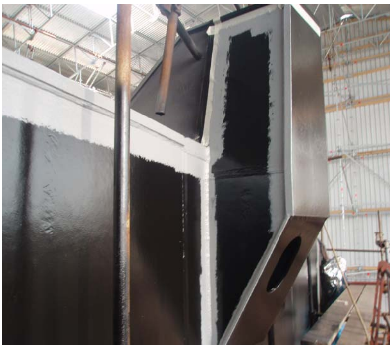
Slika 64. Nanošenje vezivne boje Hempasil nexus 27302, Brodogradilište Uljanik, Pula
