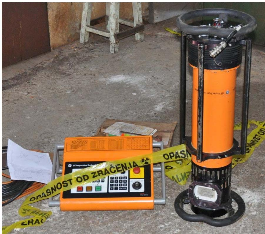
**Slika 42.** Uređaj za ispitivanje zavara radiografijom, Brodogradilište Uljanik, Pula, travanj 2010.
