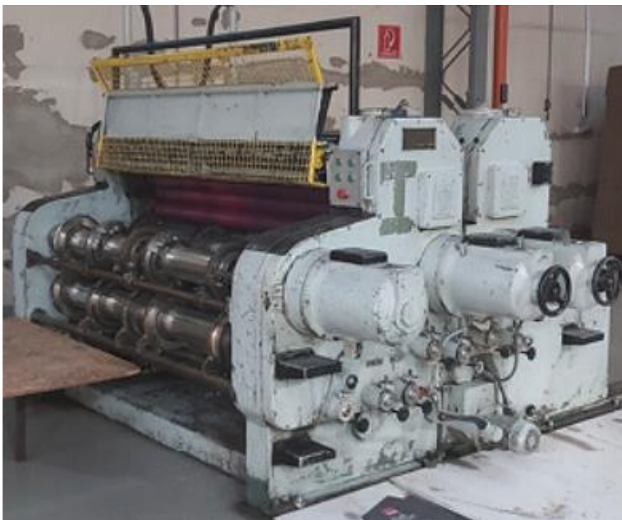
Slika 14. Sloter Gandossi & Fossati GFM 180 s fleksotiskom
