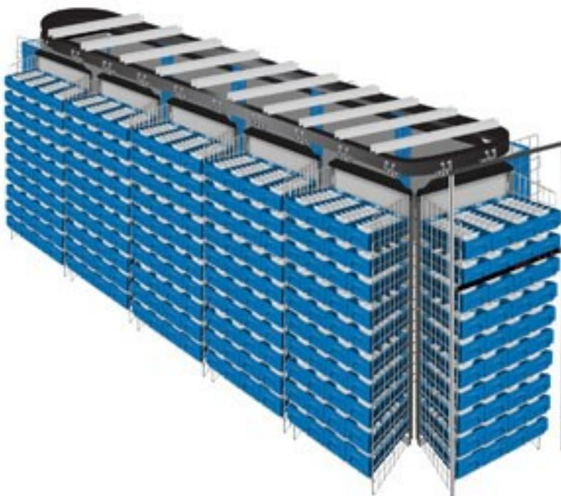
Slika 24. Primjer horizontalnog karusela [65]
