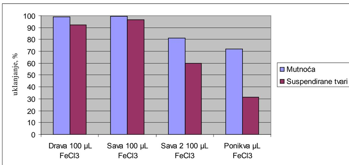
Slika 20. Uklanjanje suspendiranih tvari koagulacijom flokulacijom, taloženjem, filtracijom
