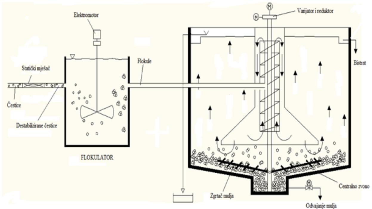
Slika 1. Prikaz odvijanja koagulacije i flokulacije [1]
