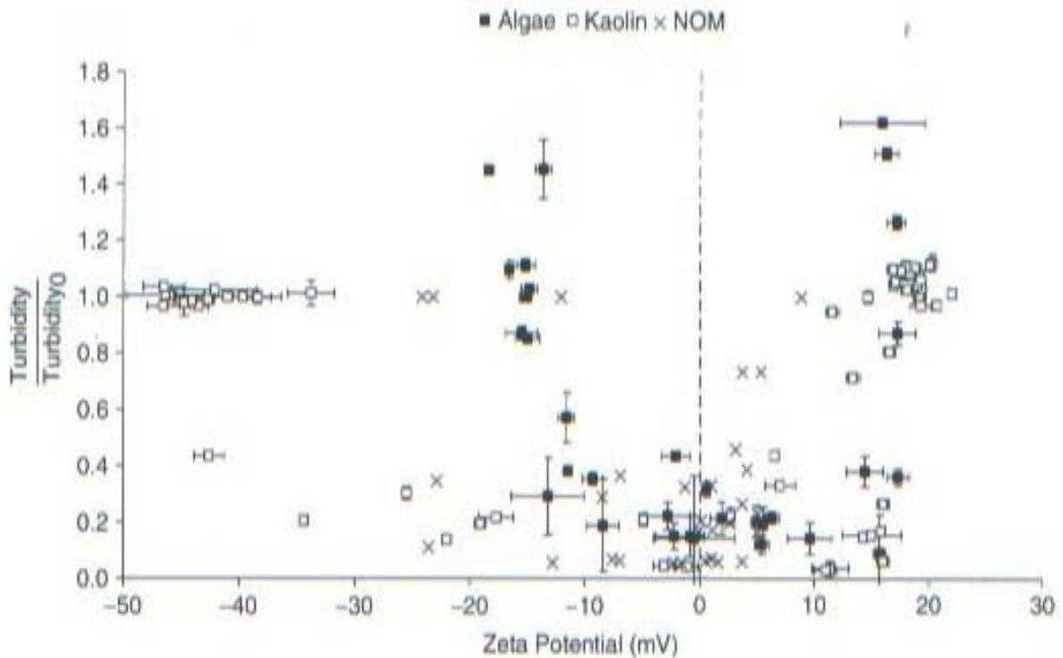
Slika 4. Korelacija između zeta potencijala i uspješnosti uklanjanja čestica nečistoće kaolina, algi i NOM [1]
