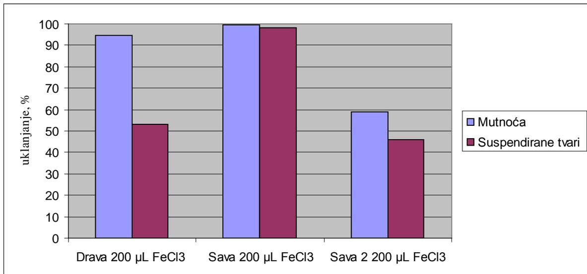
Slika 17. Uklanjanje suspendiranih tvari koagulacijom flokulacijom, filtracijom
