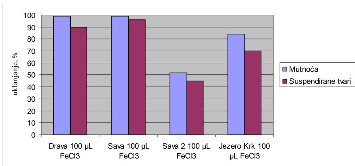
Slika 16. Uklanjanje suspendiranih tvari koagulacijom flokulacijom, filtracijom
