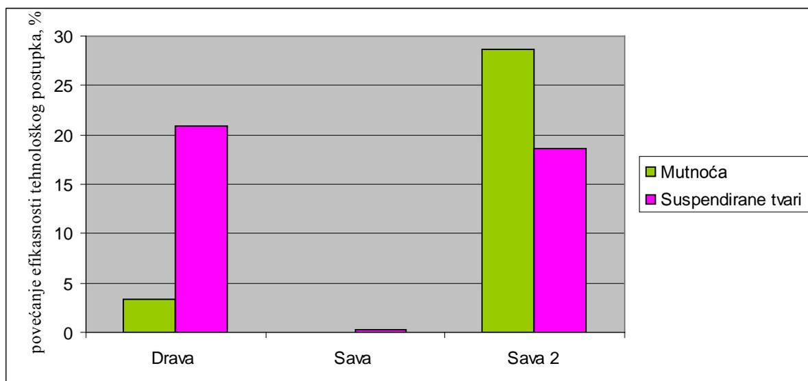
Slika 25. Utjecaj uvođenja koagulacije-flokulacije-taloženja-filtracije u odnosu na koagulaciju-flokulaciju-filtraciju
