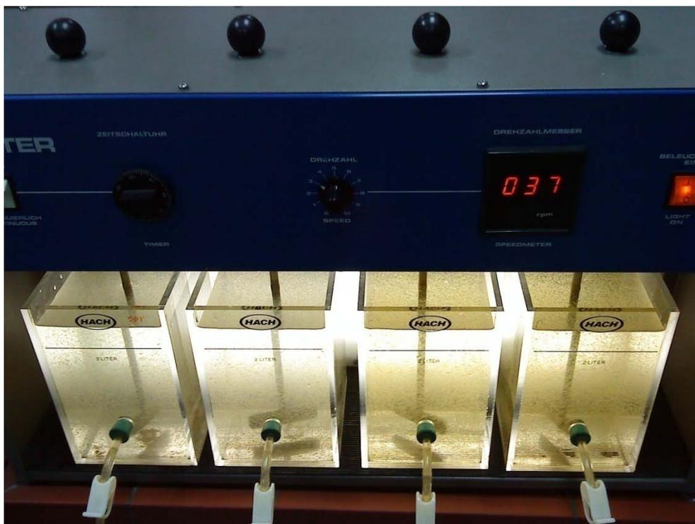
Slika 11. JAR tester (bez taloženja- lijeve dvije posude; flokulacija sa 100 uL FeCl<sub>3</sub> -desne dvije posude; flokulacija sa 200 uL FeCl<sub>3</sub>)
