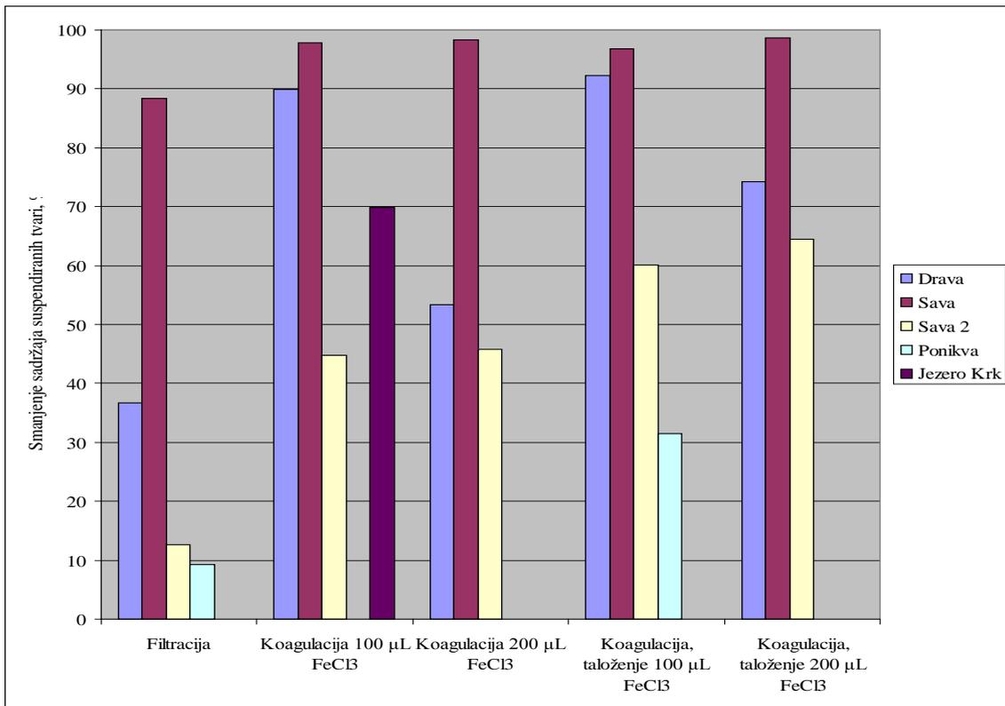
Slika 29. Smanjenje sadržaja suspendiranih tvari ovisno o postupku
