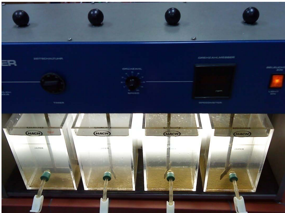
Slika 14. JAR tester (taloženje –lijeve dvije posude; flokulacija sa 100 uL \text{FeCl}_3 -desne dvije posude; flokulacija sa 200 uL \text{FeCl}_3 )
