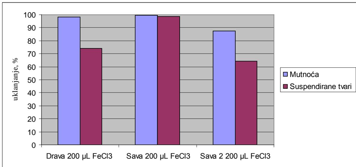
Slika 21. Uklanjanje suspendiranih tvari koagulacijom flokulacijom, taloženjem, filtracijom
