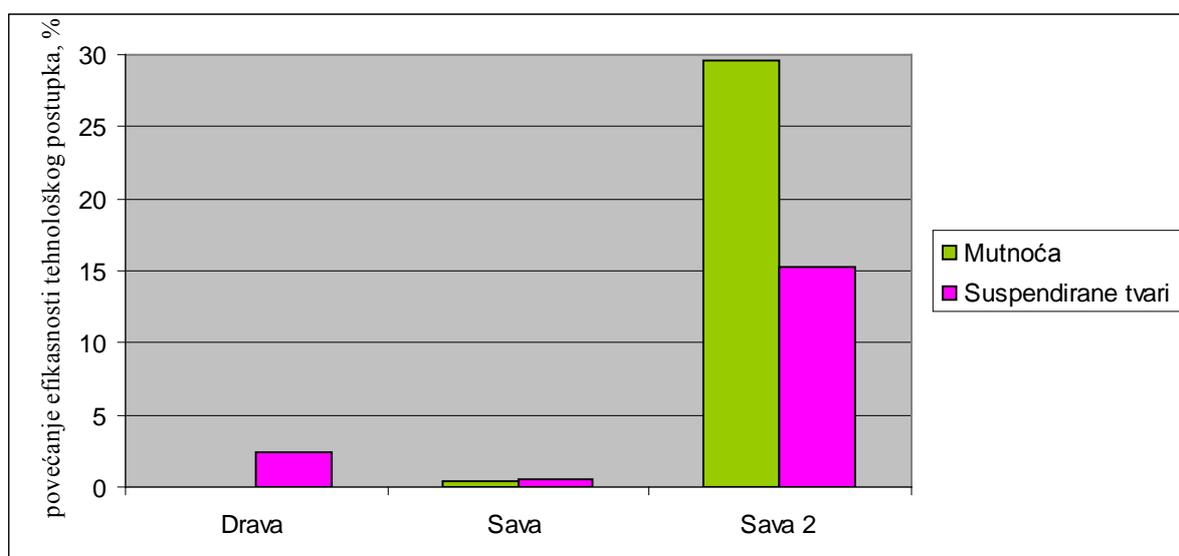
Slika 24. Utjecaj uvođenja koagulacije-flokulacije-taloženja-filtracije u odnosu na koagulaciju-flokulaciju-filtraciju
