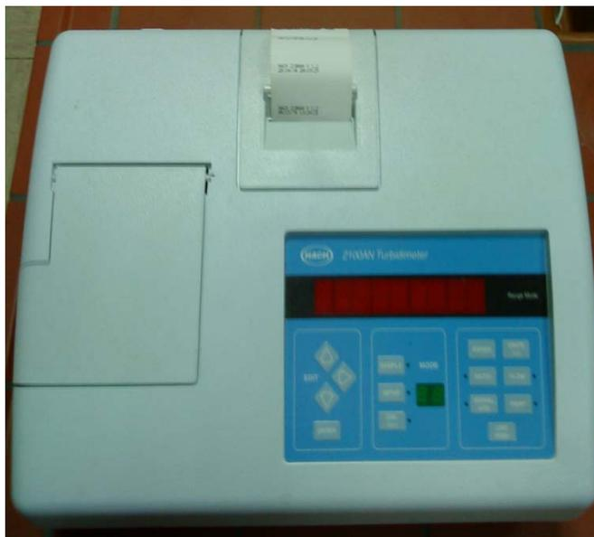
Slika 6. Turbidimetar 2100AN
