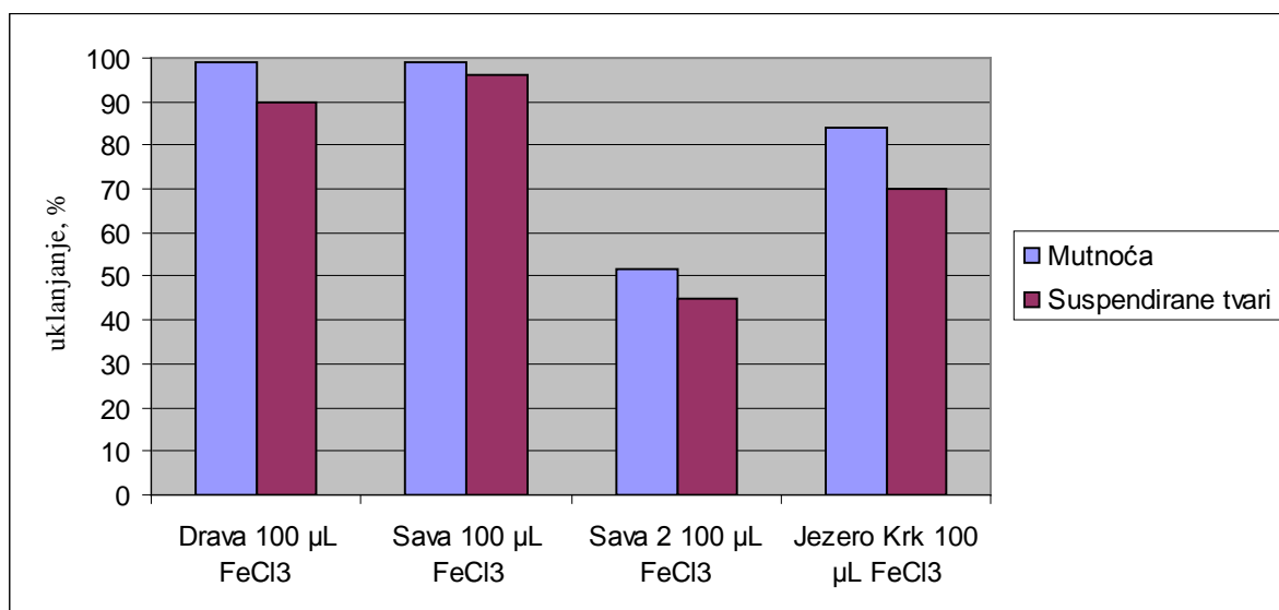
Slika 16. Uklanjanje suspendiranih tvari koagulacijom flokulacijom, filtracijom
