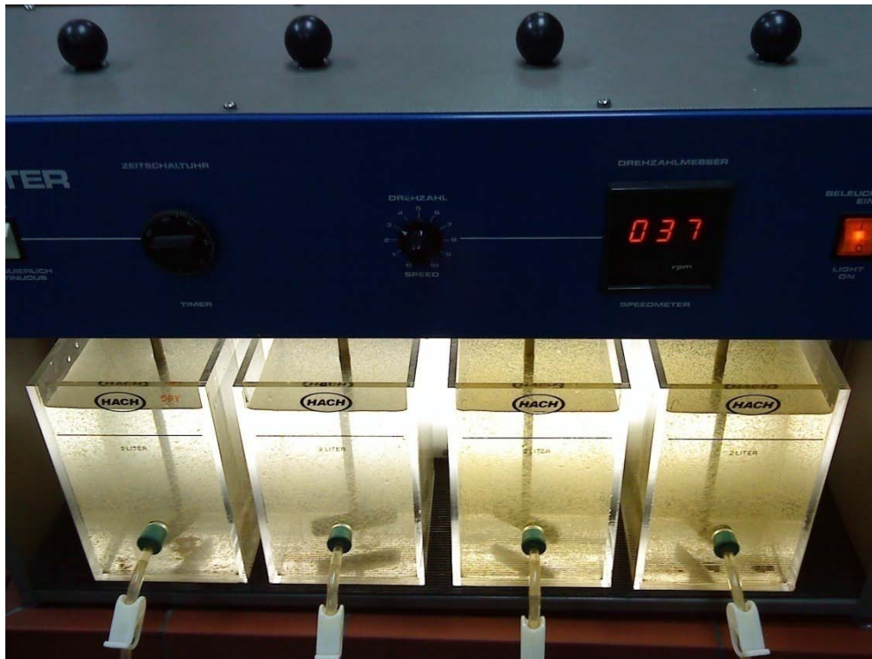
Slika 11. JAR tester (bez taloženja- lijeve dvije posude; flokulacija sa 100 uL FeCl 3 -desne dvije posude; flokulacija sa 200 uL FeCl 3 )
