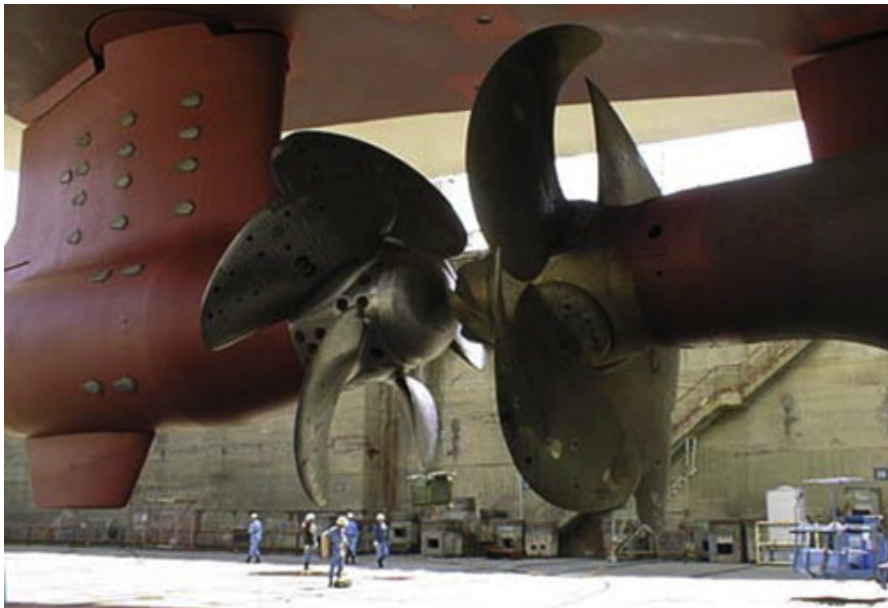
Slika 5.1: Primjer kontrarotirajućih propelera [1].
