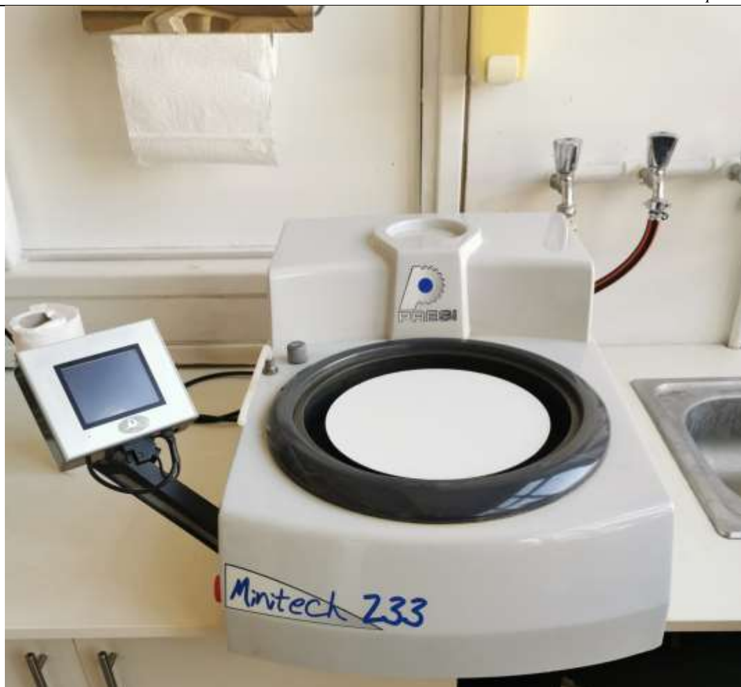
Slika 32 Uredaj za brušenje
