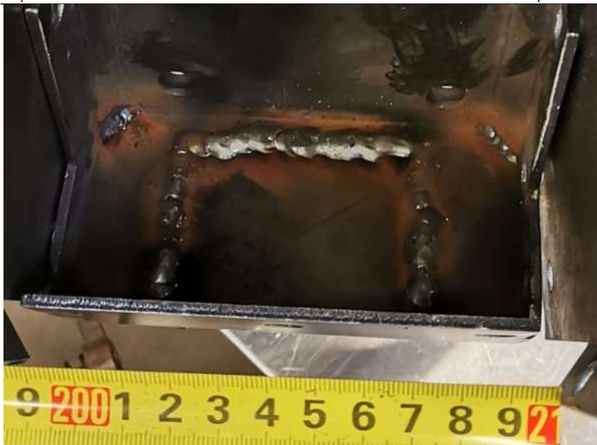
Slika 27 Zavareni spoj izveden u proizvodnom pogonu TEP-a
