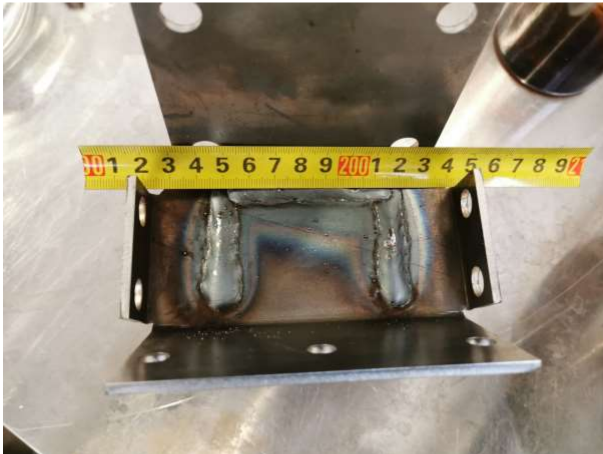
Slika 26 Završeni spoj izveden u Laboratoriju za zavarivanje na
