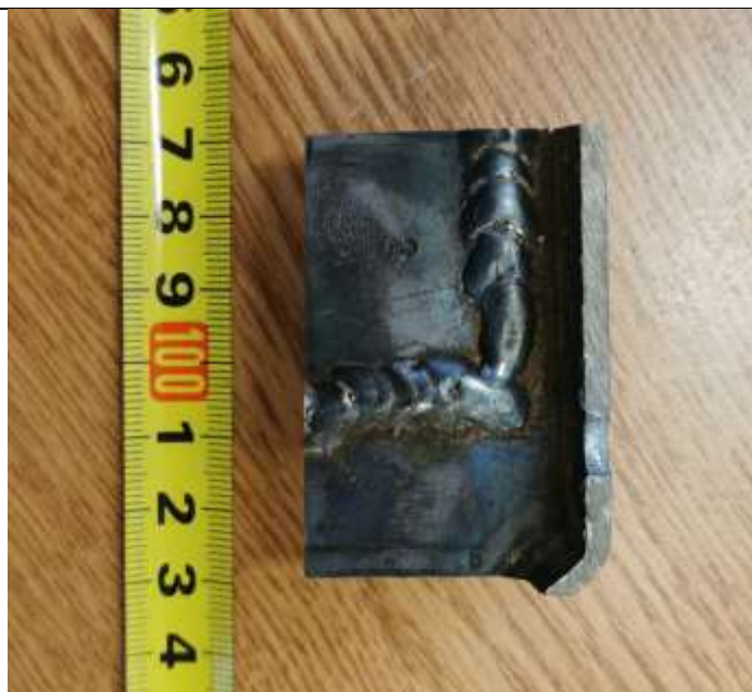
Slika 34 Makroizbrusak - uzorak 2 (TEP)
