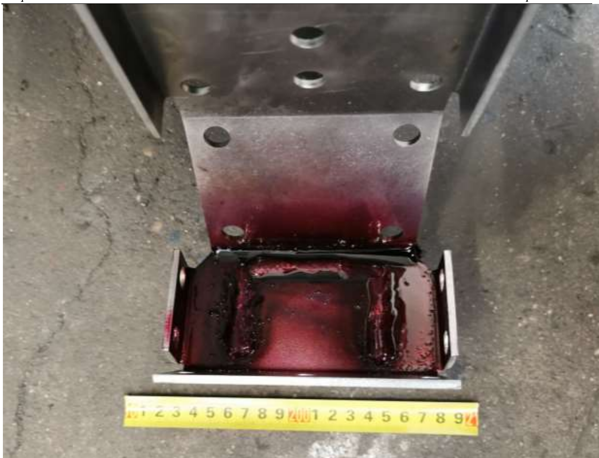
Slika 29 Penetrantsko ispitivanje zavarenog spoja
