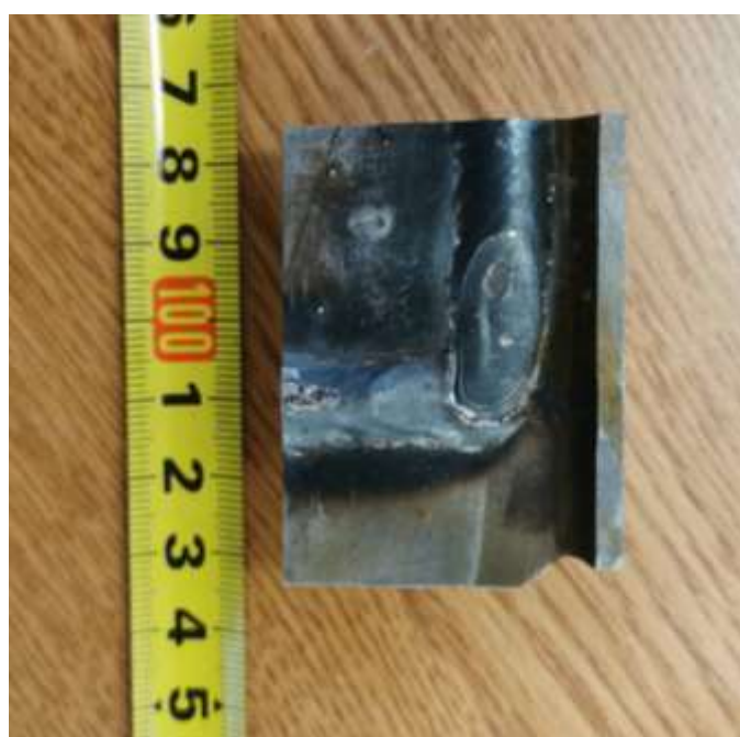
Slika 33 Makroizbrusak - uzorak 1 (FSB)
