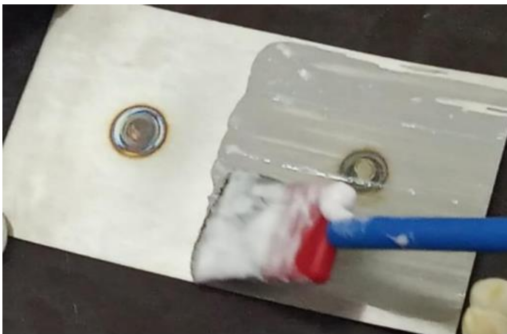
Slika 10. Prikaz kemijske obrade zavora nagrizanjem [5]
