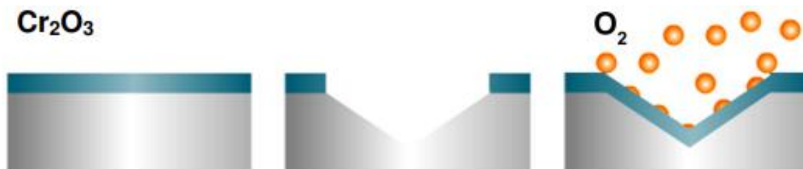
Slika 3. Shematski prikaz repasivacije prilikom oštećivanja metalne površine [2]
