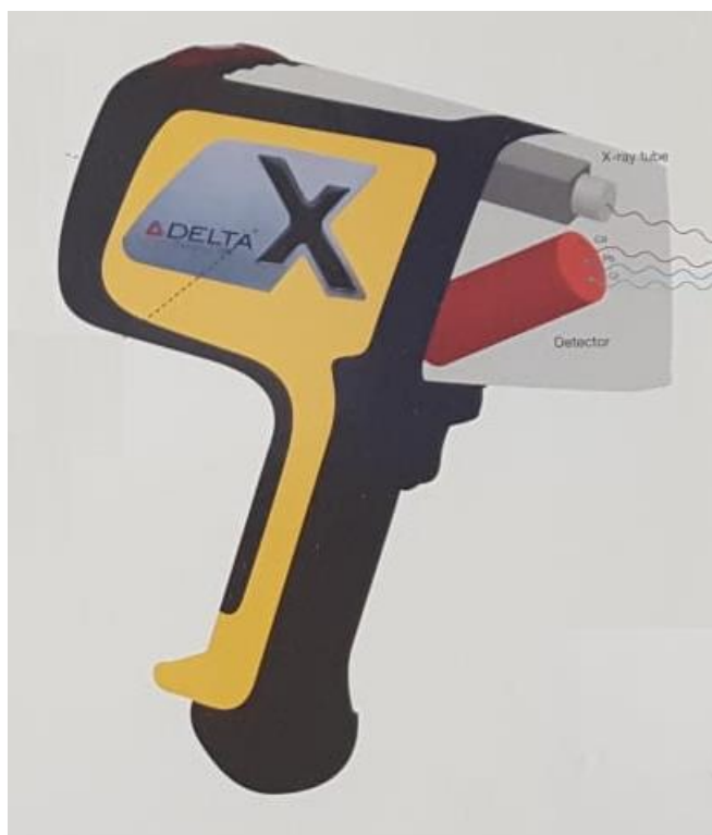
Slika 30. Ilustrirani prikaz uređaja Portable X-Ray Analyzer [37]
