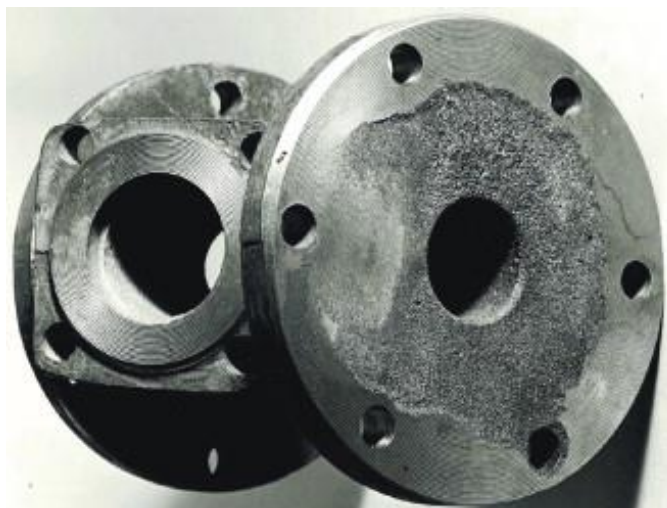
Slika 16. Primjer korozije u procjepu [21]
