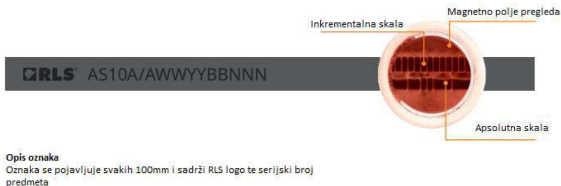
Slika 16. Struktura magnetske trake RLS AS10 [12]
