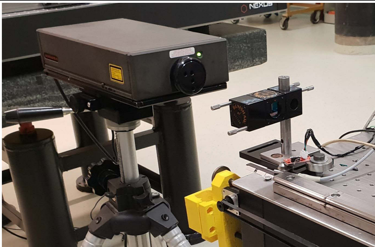
Slika 34. Laserski interferometar Renishaw ML10
