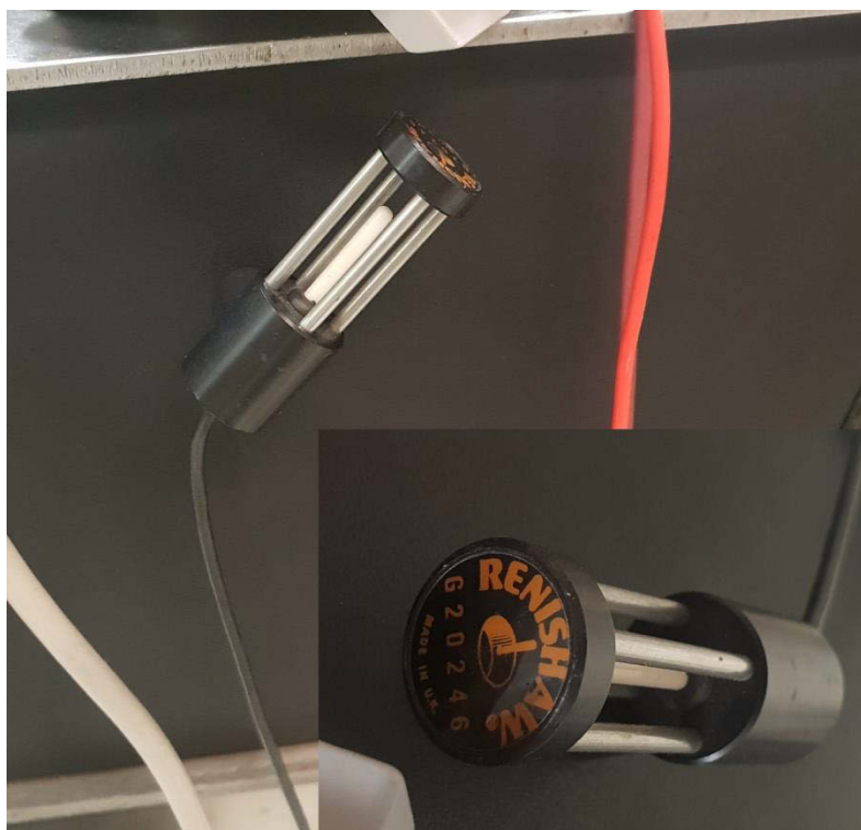
Slika 35. Mjerna sonda uređaja Renishaw EC10
