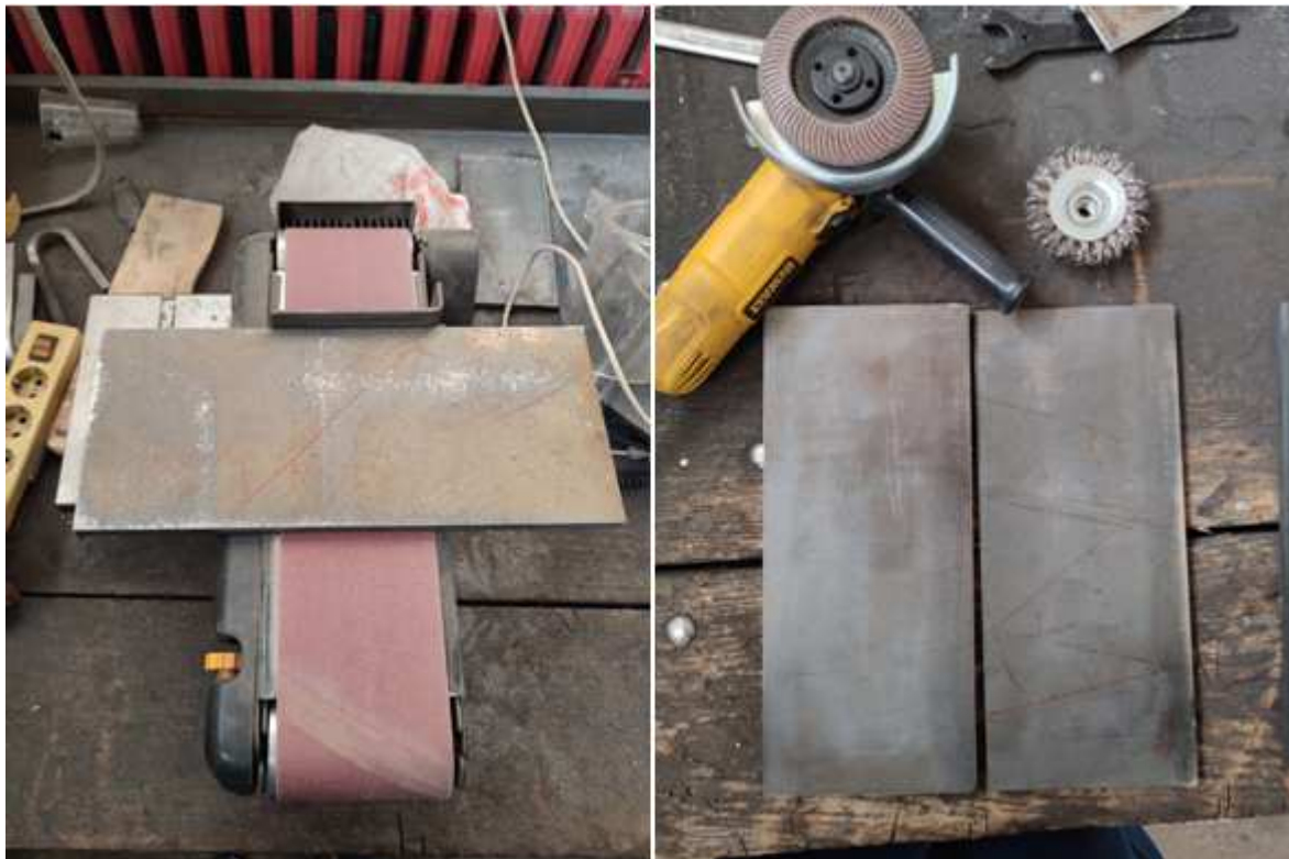
Slika 26. Obrada površine pomoću tračne i kutne brusilice
