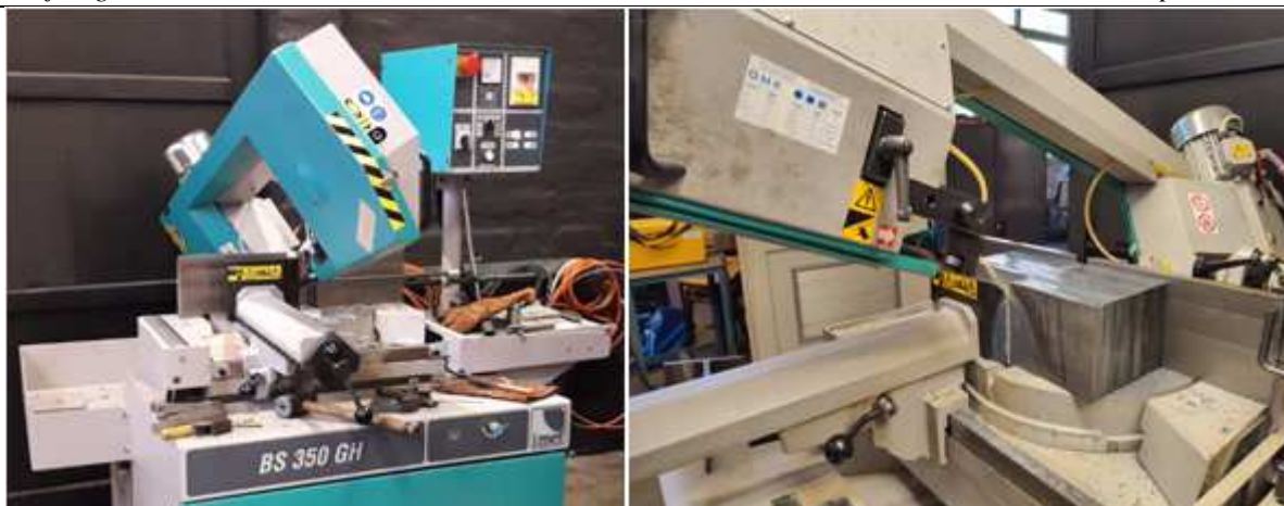
Slika 28. Skraćivanje uzoraka pomoću tračne pile
