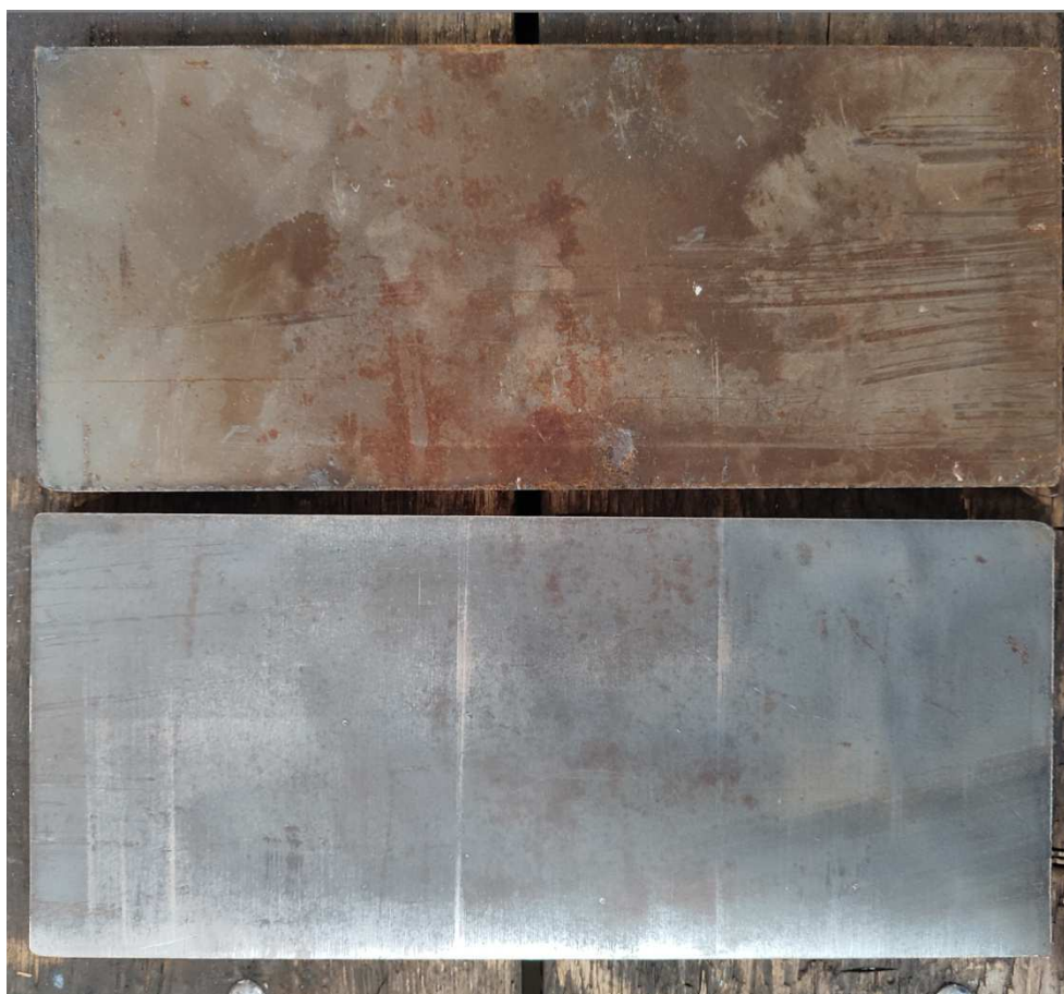
Slika 26. Obrada površine pomoću tračne i kutne brusilice
