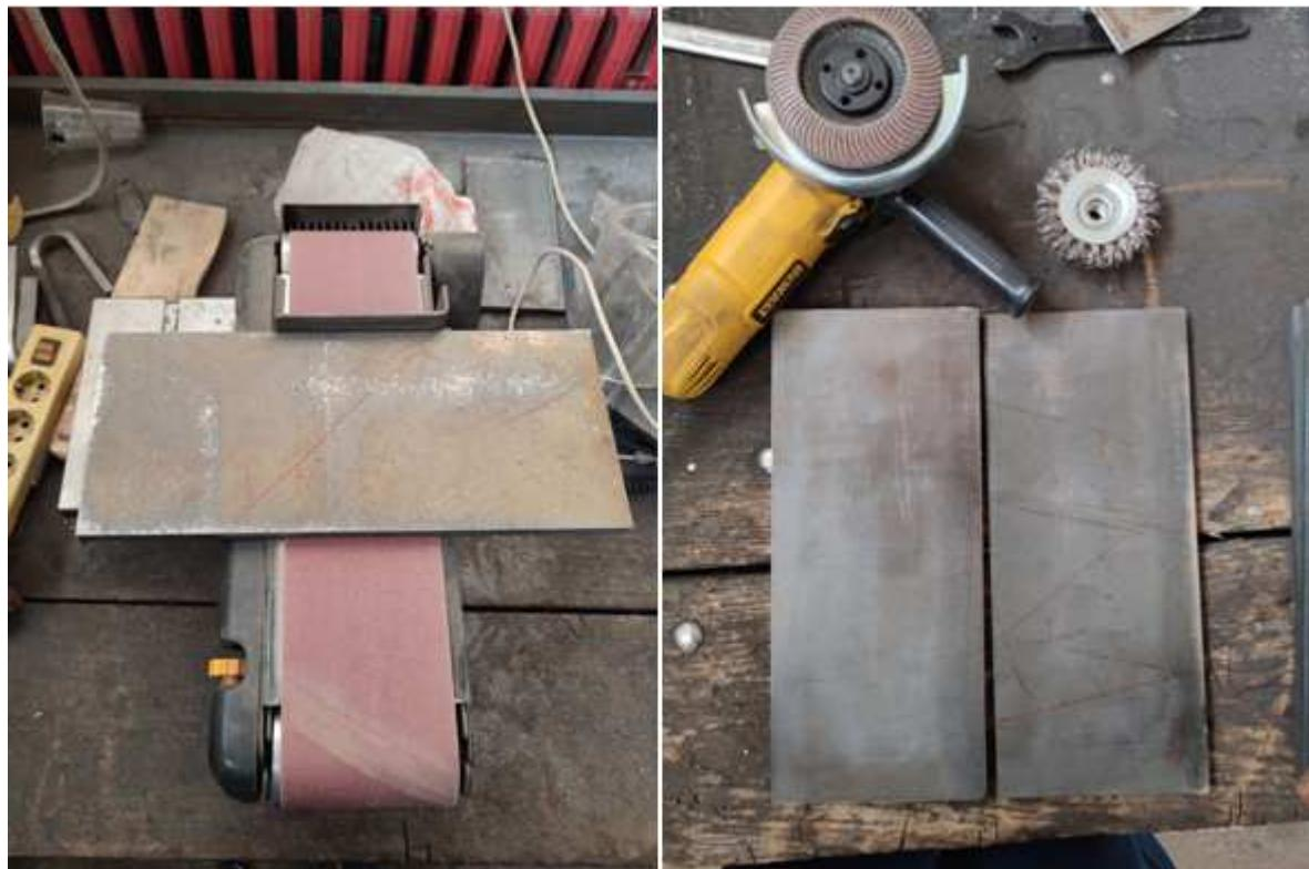
Slika 26. Obrada površine pomoću tračne i kutne brusilice
