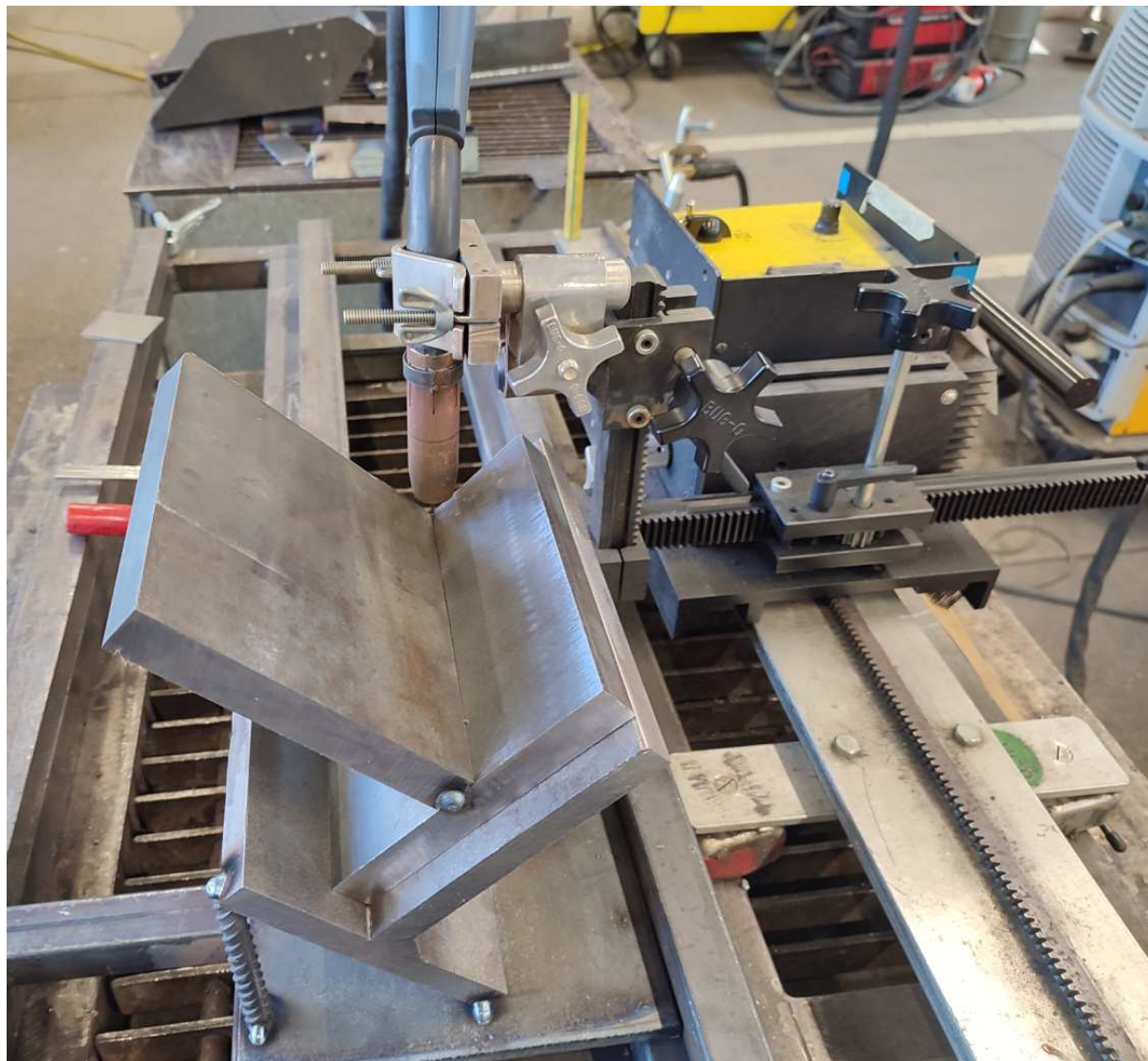
Slika 23. „BUG-O Systems“ sustav za automatsko zavarivanje
