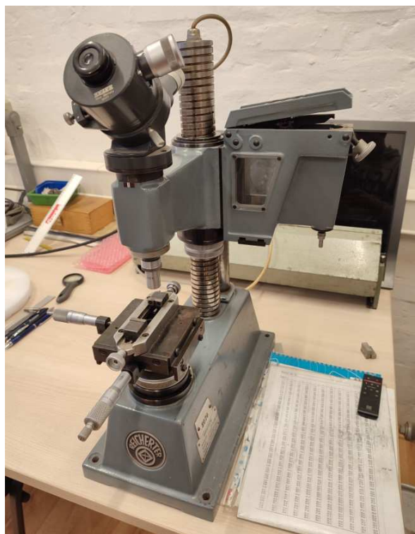
Slika 25. Uređaj za mjerenje tvrdoće „Reicherter Brivisor KL 2“
