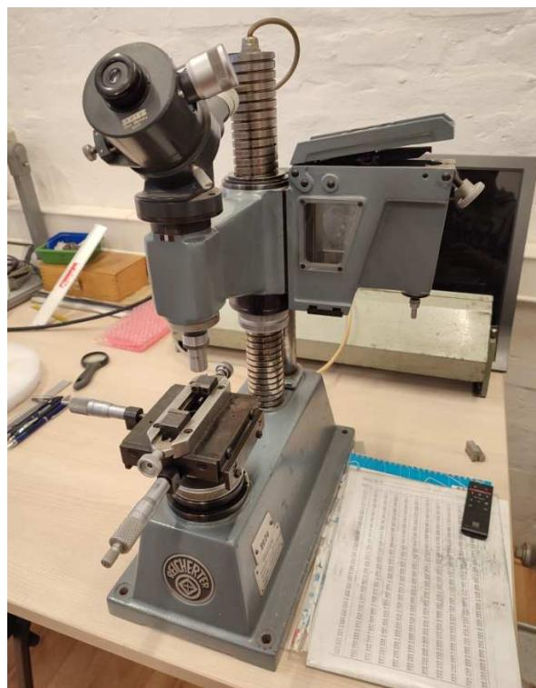
**Slika 25. Uredaj za mjerjenje tvrdoće „Reicherter Brivisor KL 2“**
