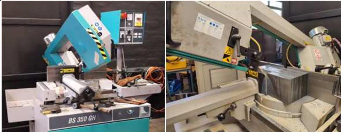
Slika 28. Skraćivanje uzorka pomoću tračne pile
