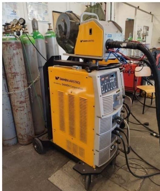
Slika 21. Uredaj za MAG impulsno zavarivanje „DAIHEN VARSTROJ WB-P500L“
