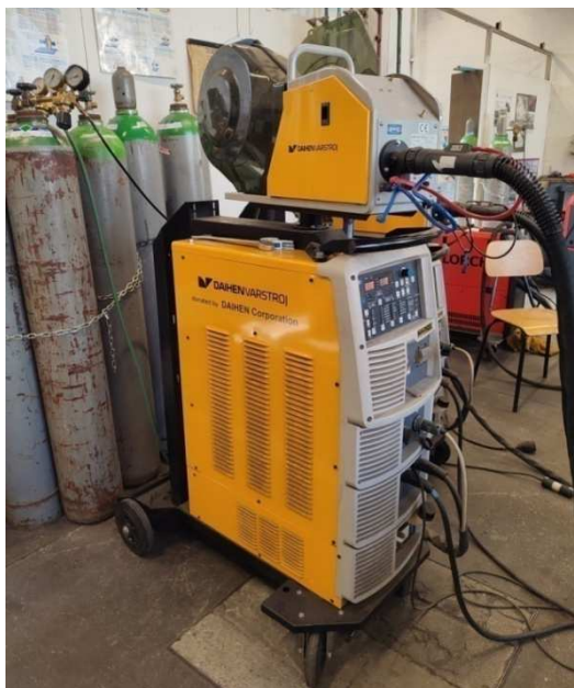
Slika 21. Uređaj za MAG impulsno zavarivanje „DAIHEN VARSTROJ WB-P500L“
