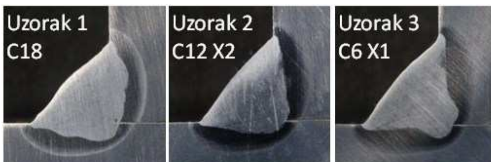
Slika 40. Utjecaj plina na oblik metala zavara
