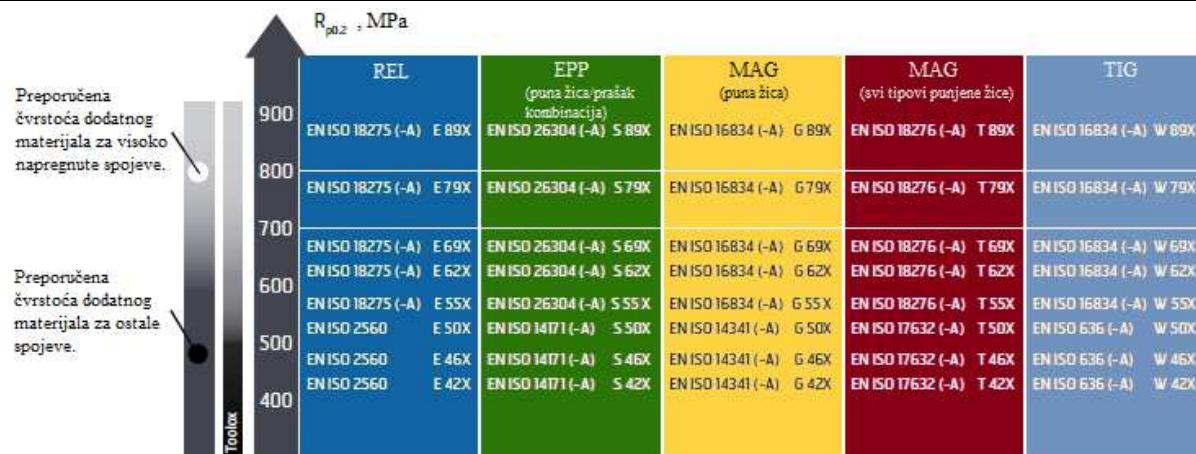
**Slika 12. Dodatni materijali za zavarivanje Toolox čelika [4]**
