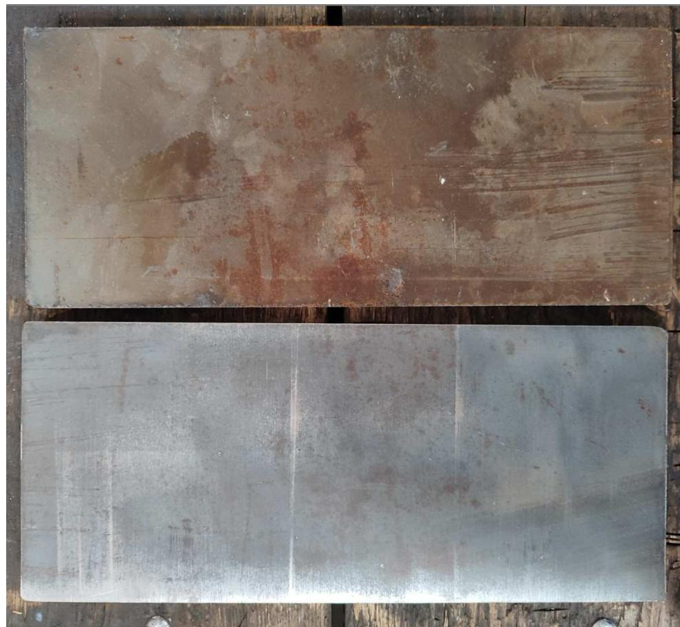
Slika 27. Stanje površine isporučenog lima (gornji lim) i očišćenog lima (donji lim)
