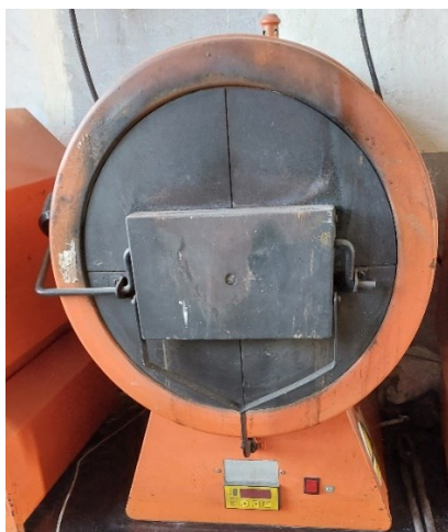
Slika 5.7 Komorna električna peć za toplinsku obradu ispitnih uzorka
