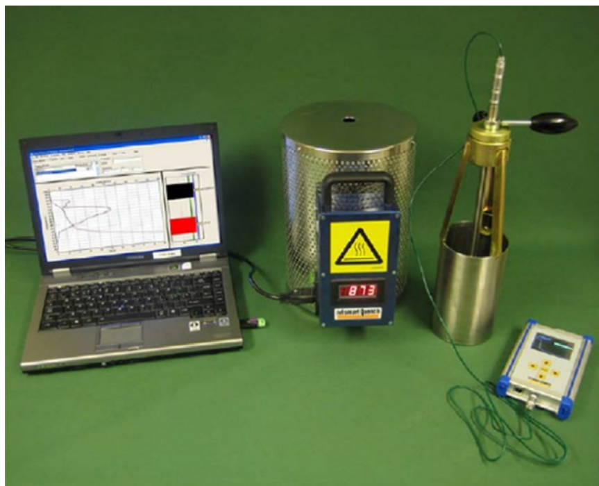
Slika 5.9 Mjerni sustav IVF Smart Quench System (ISO 9950) [30]
