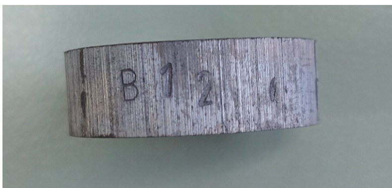
Slika 5.5 Primjer žigom označenog uzorka
