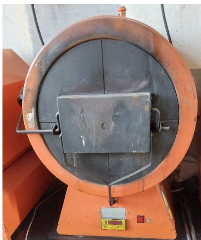
Slika 5.7 Komorna električna peć za toplinsku obradu ispitivanih uzorka
