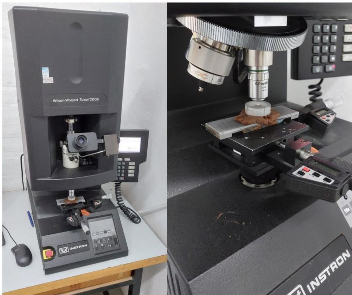
Slika 5.13 Tvrdomjer INSTRON Wilson-Wolpert Tukon 2100B (lijevo) te pripremljeni uzorak za ispitivanje tvrdoće na uređaju (desno)
