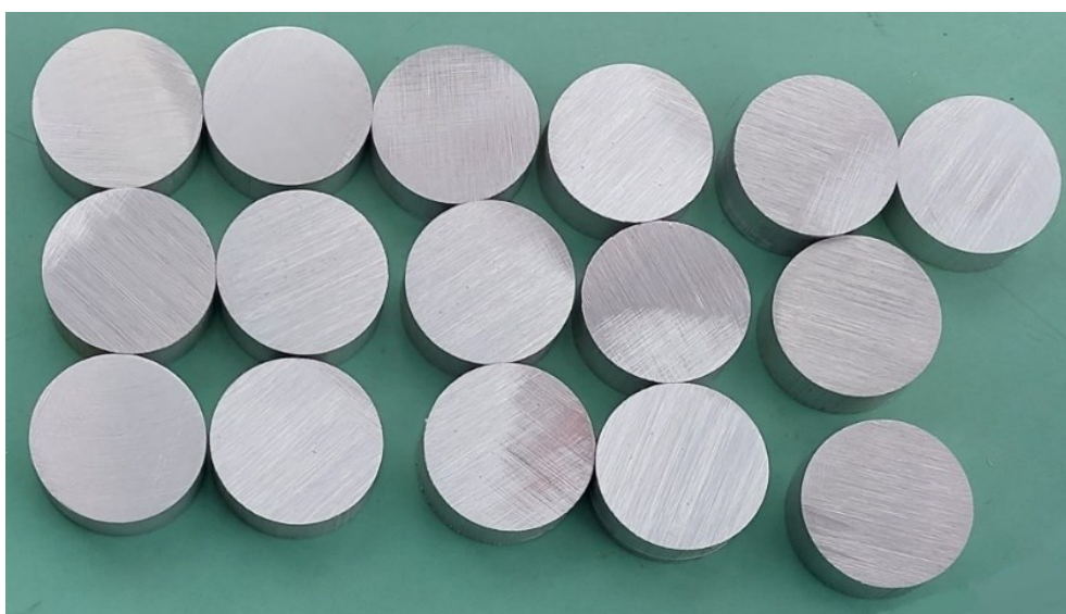
Slika 5.3 Izrezani uzorci prije pripreme površina za ispitivanja
