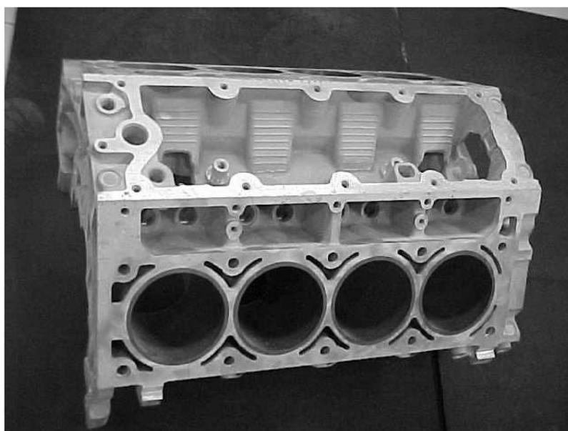
**Slika 2.2** Blok motora V8 od lijevane legure aluminija A319 AlSiCu [5]
