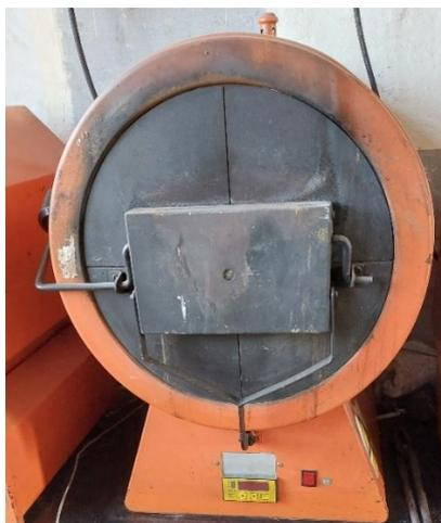
Slika 5.7 Komorna električna peć za toplinsku obradu ispitivanih uzorka
