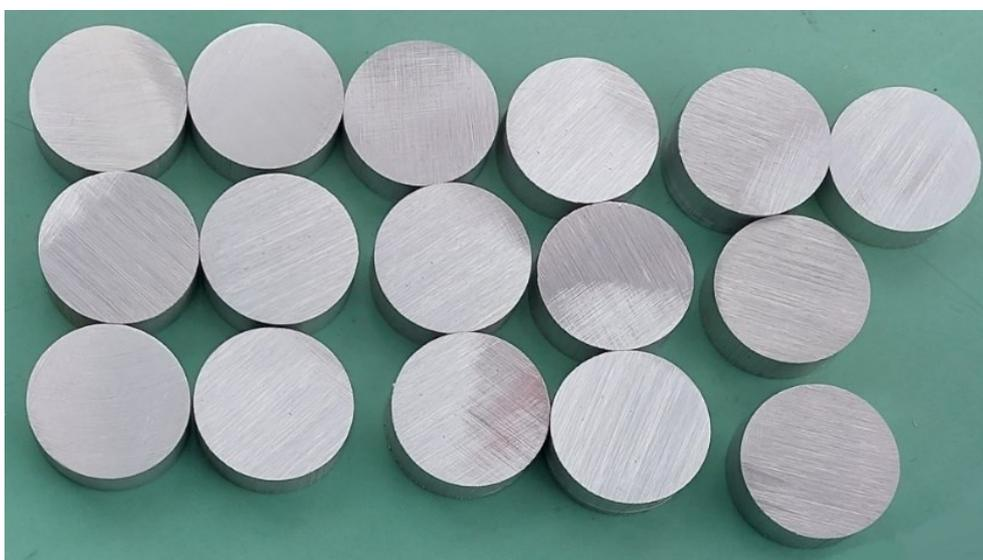
**Slika 5.3 Izrezani uzorci prije pripreme površina za ispitivanja**
