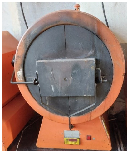
Slika 5.7 Komorna električna peć za toplinsku obradu ispitnih uzorka
