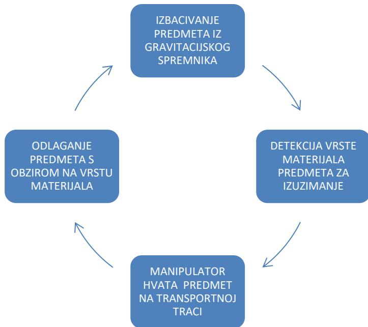
**Slika 50.** Dijagram toka za automatski način rada
