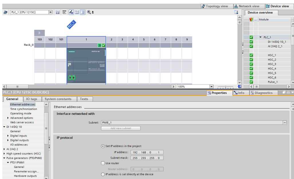
Slika 30. Postavaljanje IP adrese PLC-a
