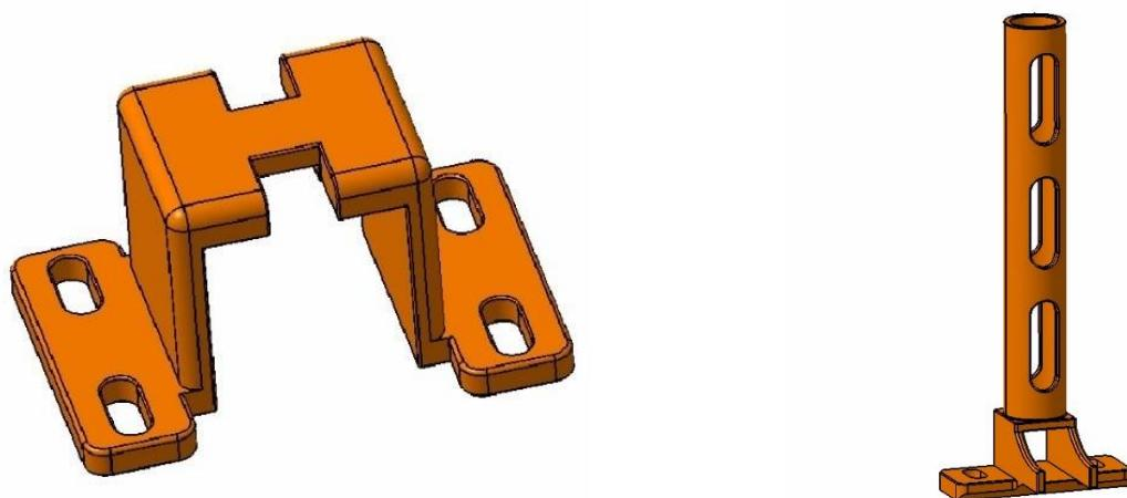
Slika 20. Nosač cilindra gravitacijskog spremnika i stupac gravitacijskog spremnika
