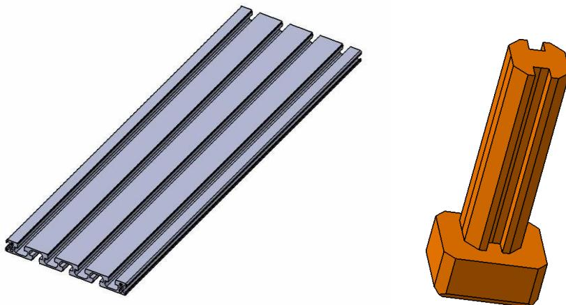
**Slika 16.****Bosch rexroth profil****Slika 17.****CAD model umetka za spoj**
