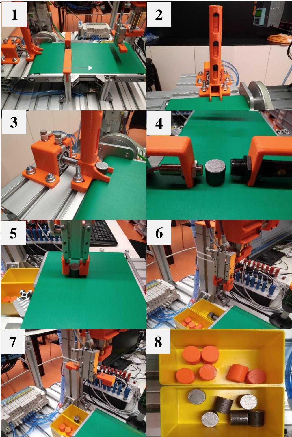
**Slika 56.** Validacija rada sustava: 1 - Transportna traka se pokreće u smjeru strelice; 2 – Gravitacijski spremnik je napunjen komadima za izuzimanje; 3 – Pneumatski cilindar izbacuje predmet rada za izuzimanje iz gravitacijskog cilindra; 4 – Komad prolazi između senzora te se detektira vrsta materijala; 5 – Manipulator hvata komad; 6 – Odnosi ga na mjesto odlaganja; 7 – Odlaže u posudu s obzirom na vrstu materijala; 8 – Razvrstani plastični i metalni komad
