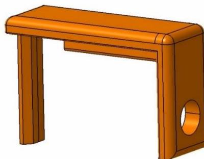
Slika 21. Nosač senzora
