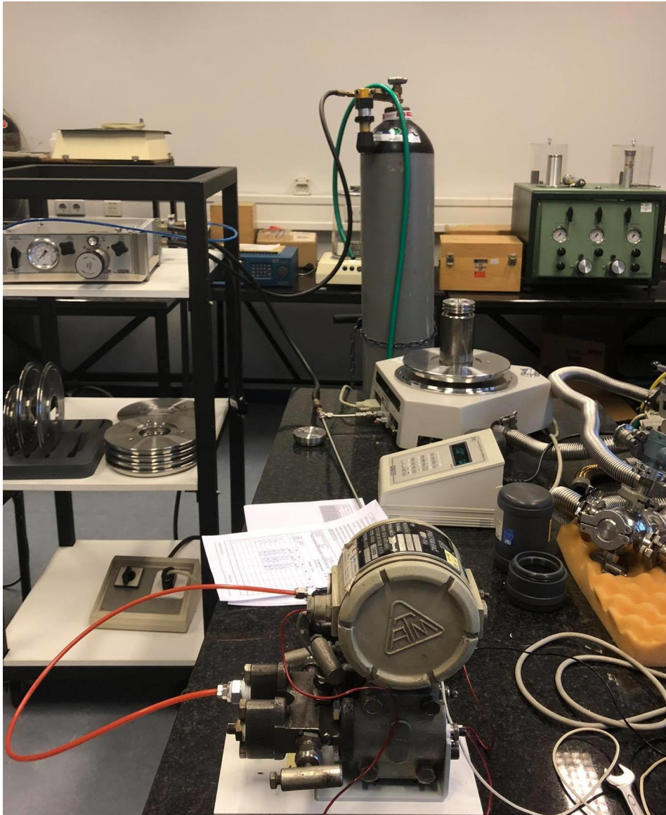
Slika 18. Umjeravanje tlačnom vagom TLVAG 09
