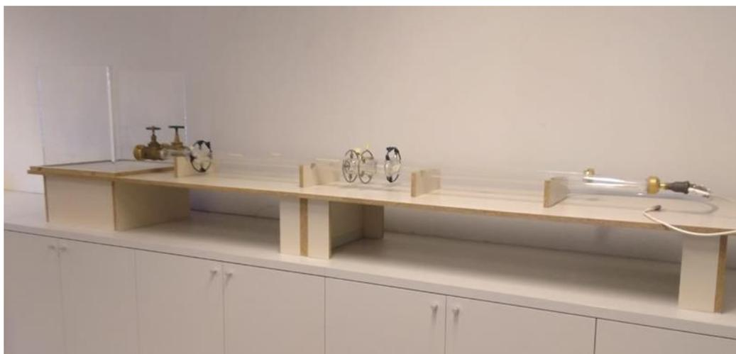
Slika 14. Mjerna staza za ispitivanje srčane pumpe
