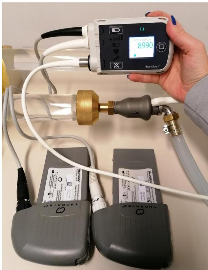
Slika 12. HeartMate II sa upravljačkom jedinicom i baterijama
