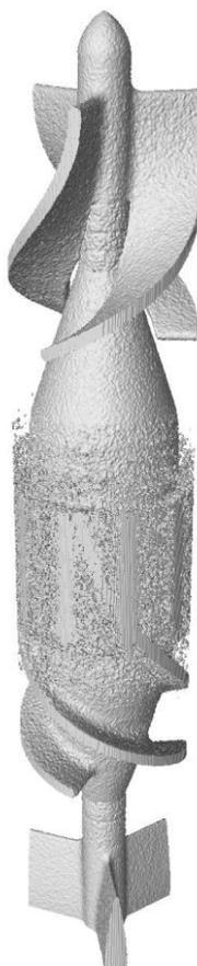
Slika 26. Detalj statora i rotora HM2 pumpe
