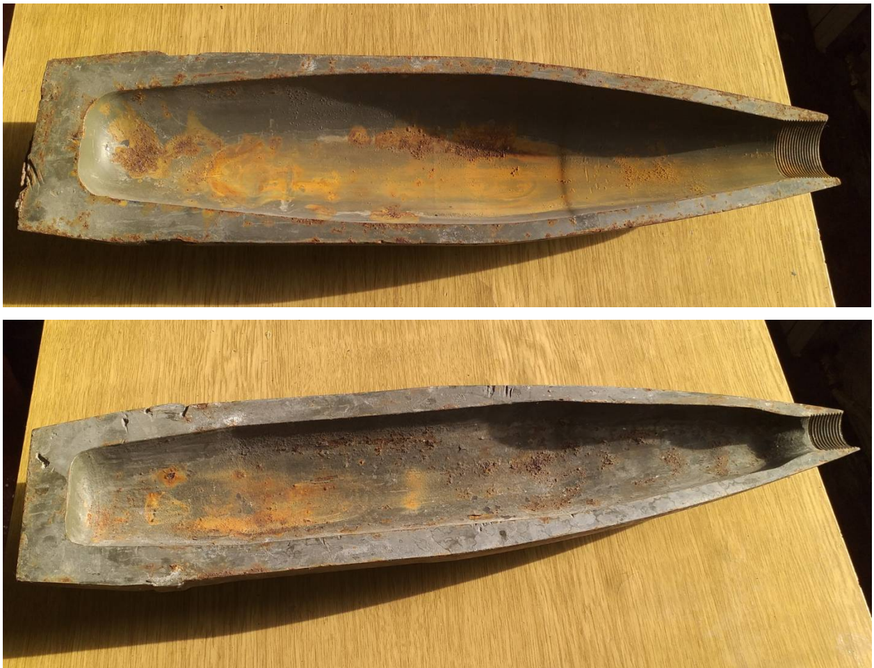
Slika 2.1. Presjeci granata, vidljiva vrlo neprecizna izvedba
