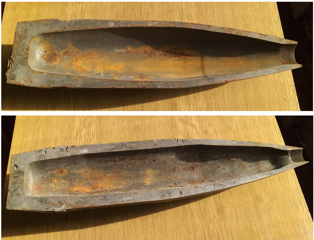
Slika 2.1. Presjeci granata, vidljiva vrlo neprecizna izvedba
