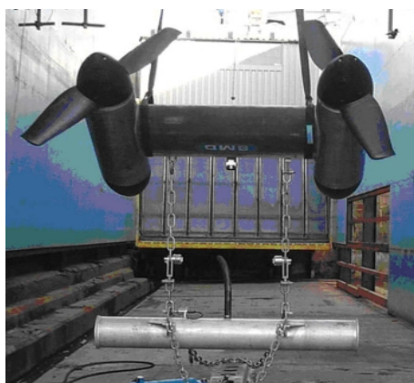
Slika 9. TidEl plimna turbina
