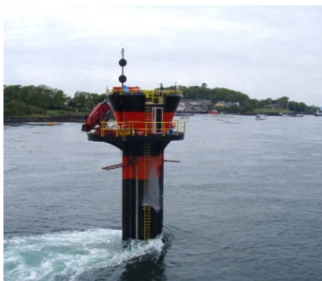
Slika 8. SeaGen plimna turbina
