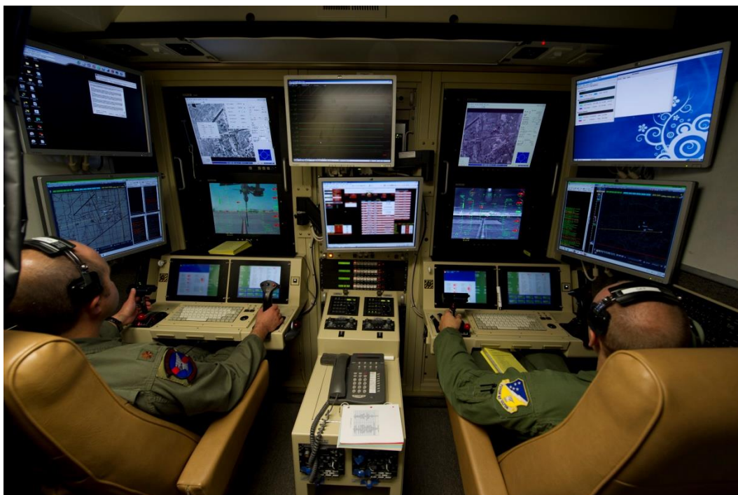
Slika 2. Zemaljska postaja za MQ-9 Reaper [2]
