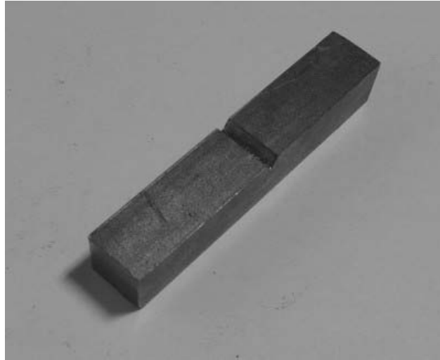
Slika 6. Epruveta nakon brušenja
