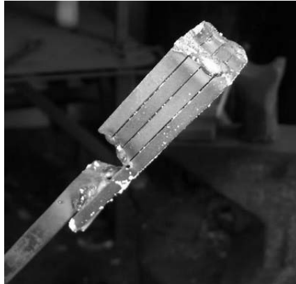
Slika 1a. Osiguravanje kontakta sljubnica zavarom
