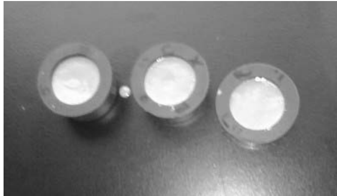
Slika 10. Uzorci u kalupima zaliveni smolom.
