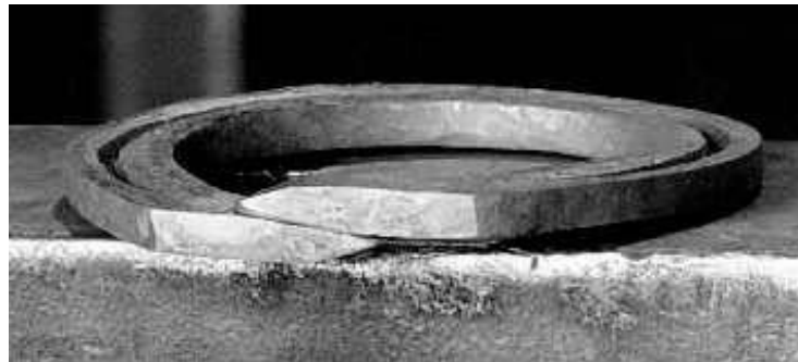
Slika 1b. Osiguravanje kontakta sljubnica oblikom obratka
