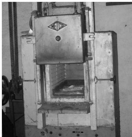
Slika 5. Električna peć u kojoj je proveden sferoidizacija
