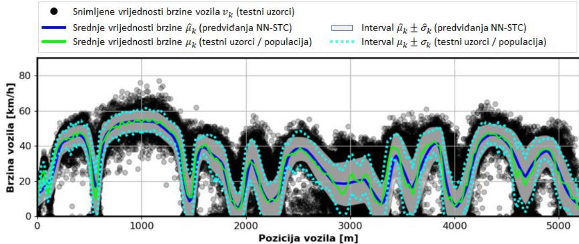
*Slika 7-9: Predviđeni i stvarni profili srednje vrijednosti brzine vozila, zajedno s pripadnim intervalima pouzdanosti i rasipanjem snimljenih vrijednosti brzine vozila, sve dobiveno za testni skup podataka.*
