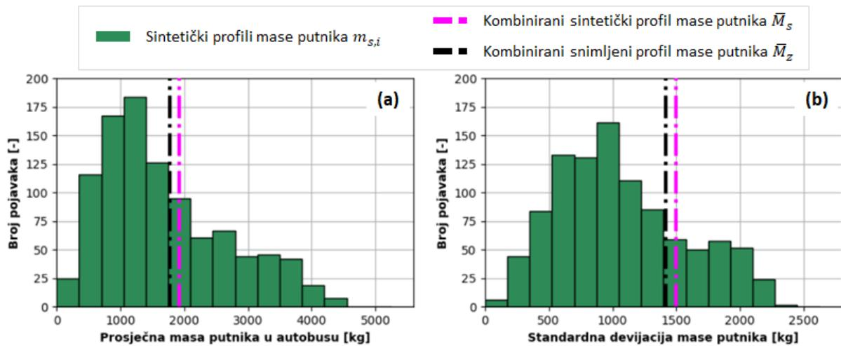
Slika 3-10: Histogrami a) prosječnih vrijednosti i b) standardnih devijacija mase putnika, izračunatih za svaki individualni sintetički vozni ciklus  $m_{s,i}$ , uključujući vrijednosti izračunate za kombinirani sintetički te snimljeni profil mase putnika.
