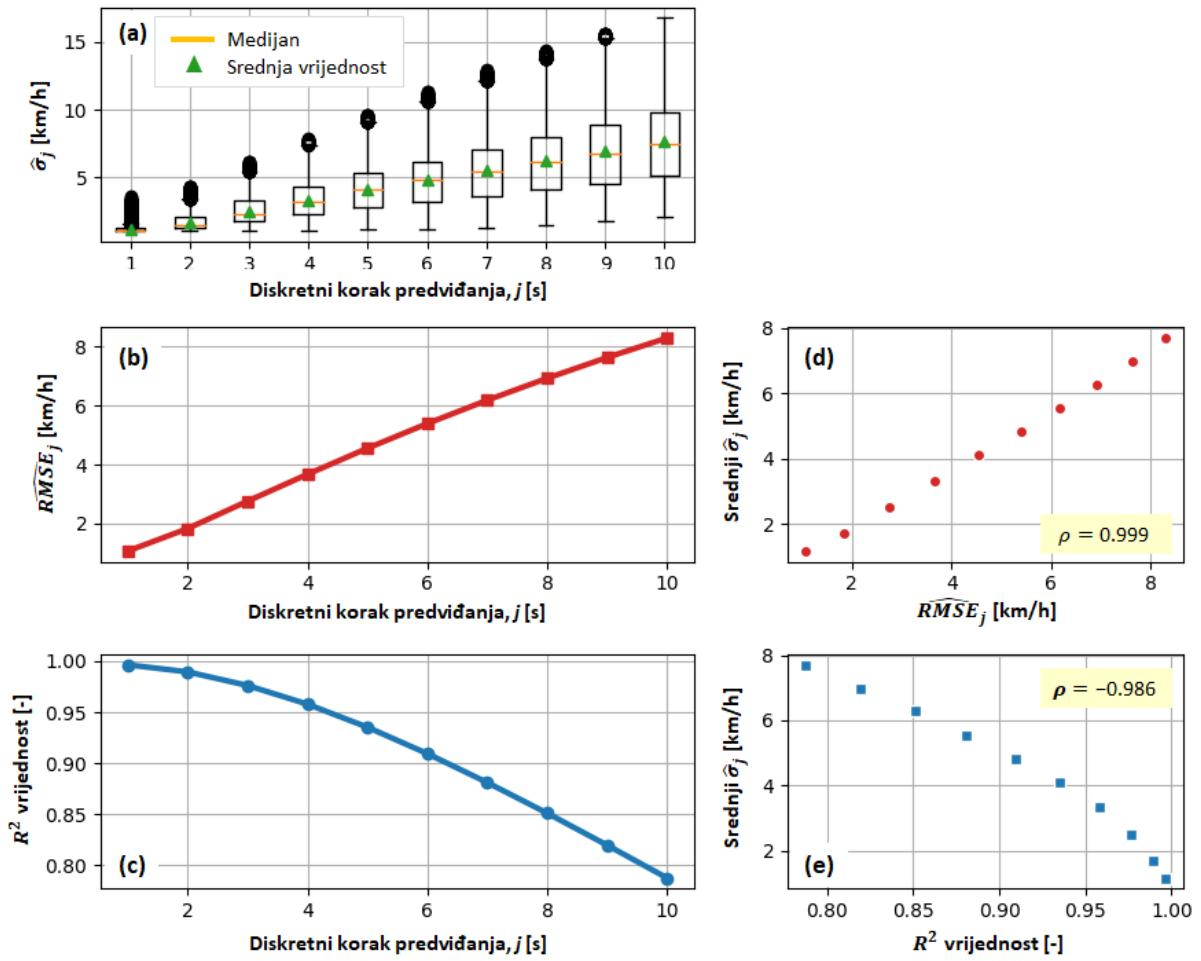
Slika 7-24: Ovisnost točnosti predviđanja NN-DSTC modela o diskretnom koraku duž horizonta predviđanja  $j = 1, 2, \dots, H_p$ , izražena kroz a) kutijasti dijagram standardne devijacije  $\hat{\sigma}_j$ , b) prosječni  $\widehat{RMSE}_j$ , te c)  $R^2$  vrijednost, uključujući međuvisnosti pokazatelja d)  $\widehat{RMSE}$  i e)  $R^2$  o  $\hat{\sigma}_j$ ; gdje  $\rho$  predstavlja odgovarajuće indekse korelacije.
