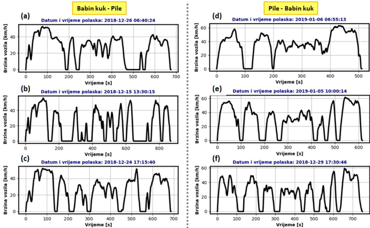
Slika 2-4: Primjeri raznih valjanih snimljenih voznih ciklusa za smjer a) Babin kuk-Pile i b) Pile-Babin kuk.
