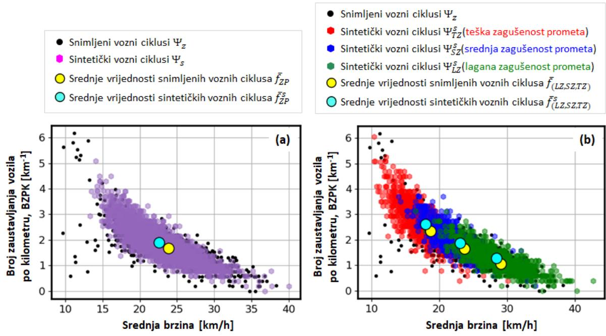
*Slika 3-11: Razdiobe značajki zagušenja prometa sintetičkih i snimljenih voznih ciklusa uključujući pripadne srednje vrijednosti značajki, za slučajeve a) sveukupnog skupa podataka i b) uzimajući u obzir informaciju o stupnju zagušenosti prometa.*
