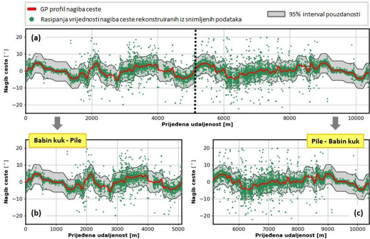
*Slika 2-7: a) Konačni profil nagiba ceste rekonstruiran za odabranu rutu uporabom regresijske metode temeljene na GP-u, zajedno s individualnim profilima nagiba ceste za smjer b) Babin kuk-Pile i c) Pile-Babin kuk.*
