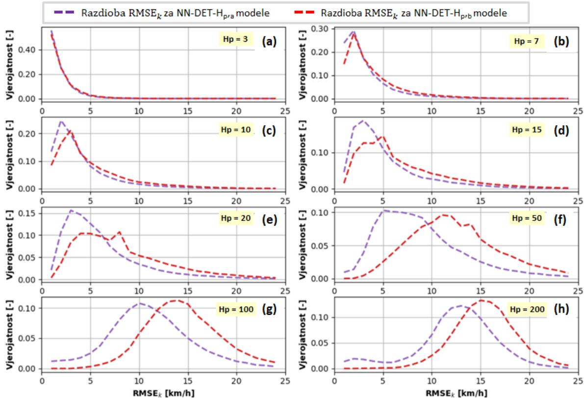
Slika 7-18: Razdiobe vrijednosti pokazatelja RMSE <sub>$k$</sub>  dobivenih za sva individualna predviđanja profila brzine vozila i danih za različite duljine horizonta predviđanja  $H_p$ .
