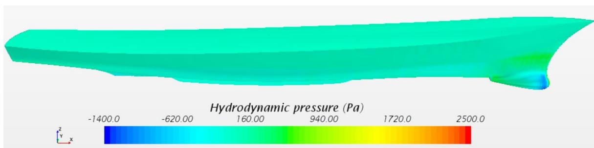
**Slika 35. Raspodjela hidrodinamičkog tlaka po trupu modela broda s ljuljnim kobilicama**
