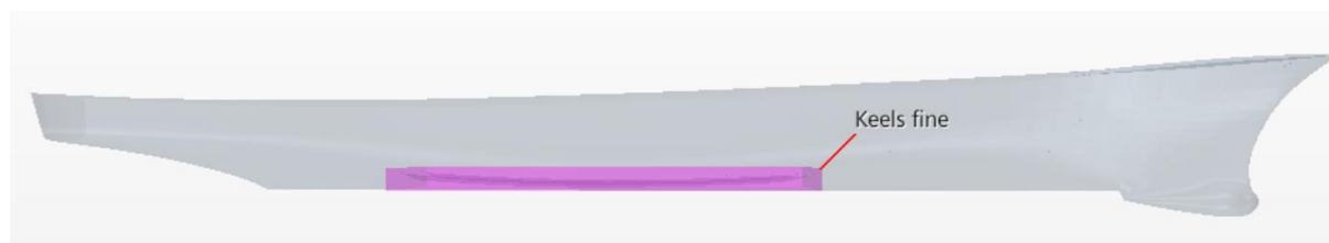
Slika 22. Volumetrijska kontrola oko ljuljnih kobilica
