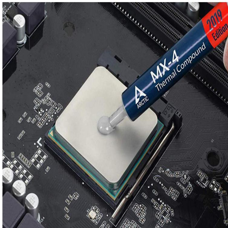
Slika 1.1: Primjer nanošenja toplinske paste na procesor [1]
