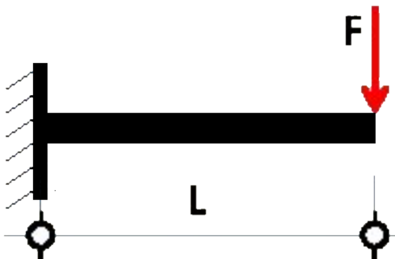
Slika 14. Konzola opterećena silom na slobodnom kraju
