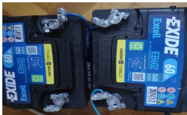
Slika 34. 12V akumulatori spojeni u seriju
