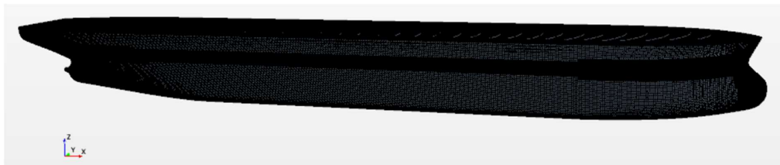
Slika 17. Model broda diskretiziran finom mrežom
