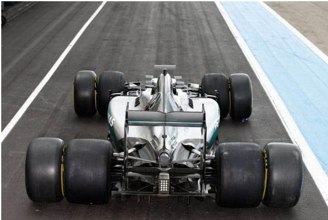
Slika 21. Usporedba širine pneumatika prije i poslije 2017. godine [20]
