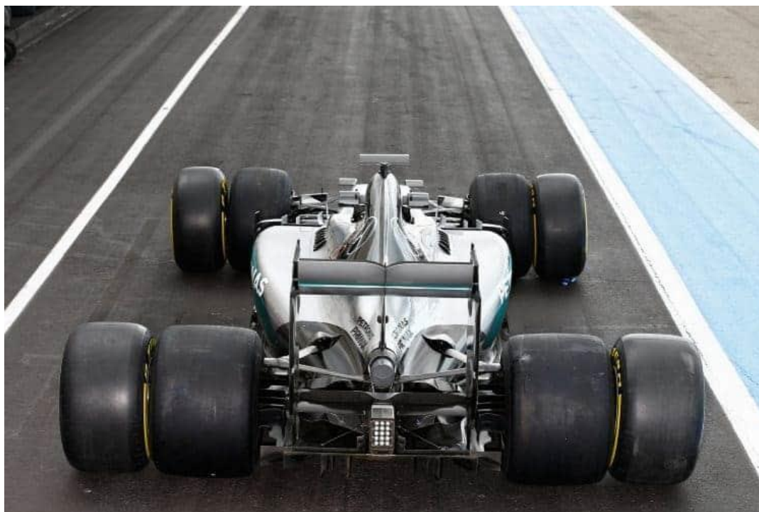
Slika 21. Usporedba širine pneumatika prije i poslije 2017. godine [20]
